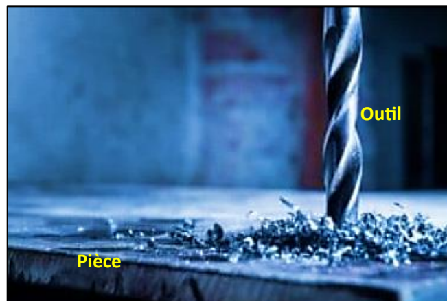
Figure II.3 : Procédé de perçage [26].
