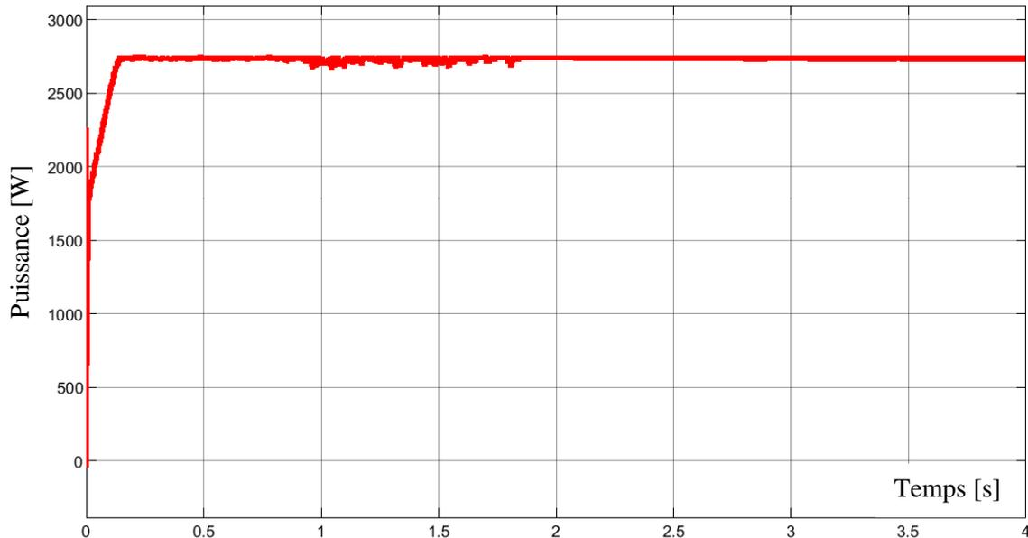
Figure III-16 : Puissance débitée par le générateur PV.
