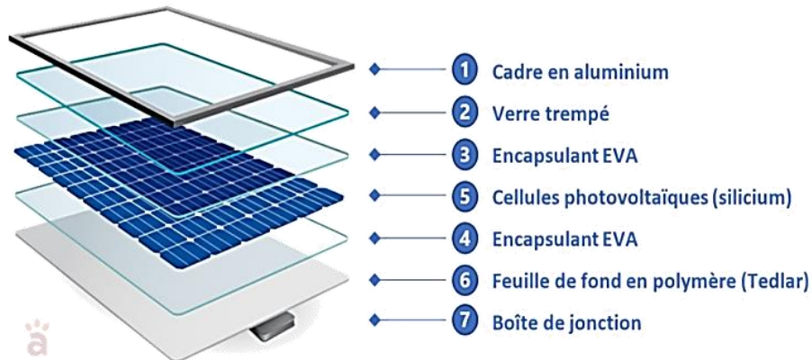
Figure I-2 : Constituants d'un module PV
