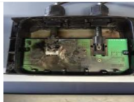
Figure I-24 : Exemple de défaut de diode de by-pass
