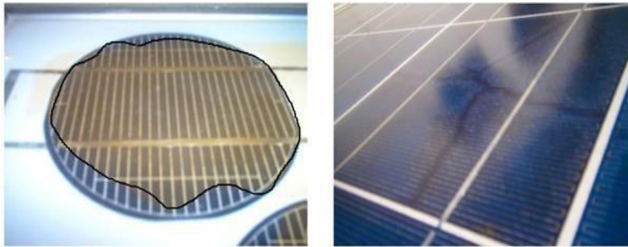
Figure I-17 : Dégradation des modules photovoltaïques par décoloration
