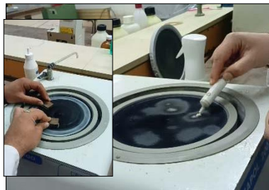
Figure III.4 : Polissage de finition des échantillons.
