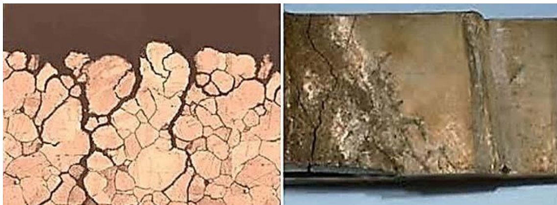
Figure I-10 : Corrosion sous contrainte [8].
