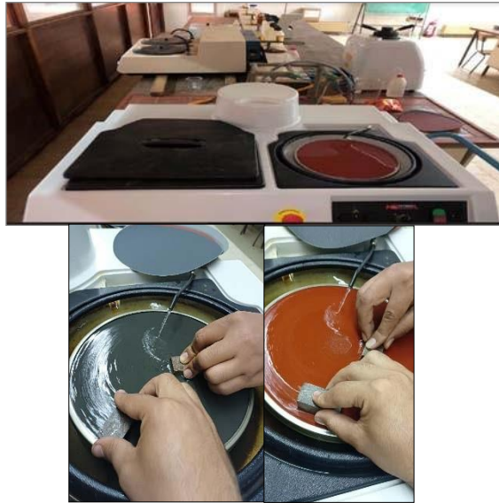
Figure III.2 : Pré-polissage des échantillons.
