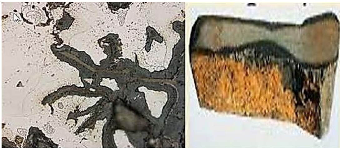
Figure I.8 : Exemples de corrosion sélective [8].
