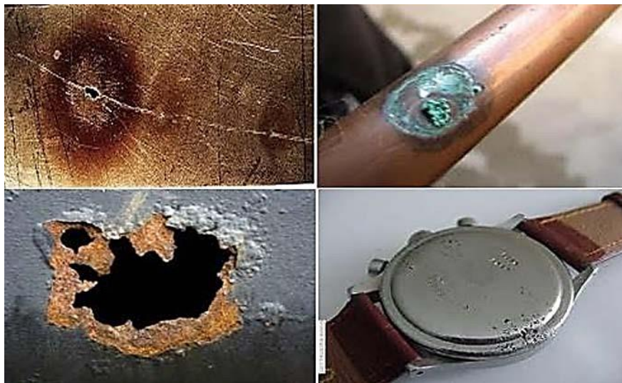
Figure I.3 : Quelques exemples de corrosion par piqûres [8].
