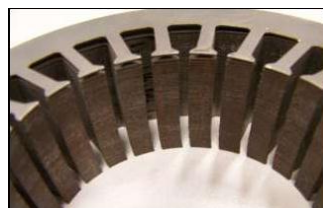
B-Stator feuilleté sans bobinage
