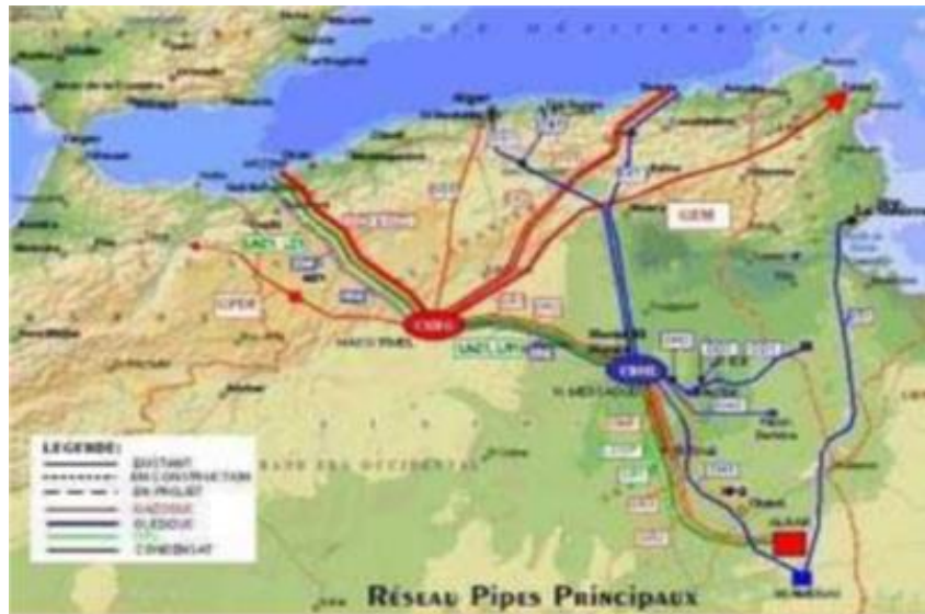
Figure 2.1 Réseau des principaux pipelines [10].
