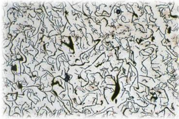
Figure I. 2: Microstructure de la fonte grise [5]
