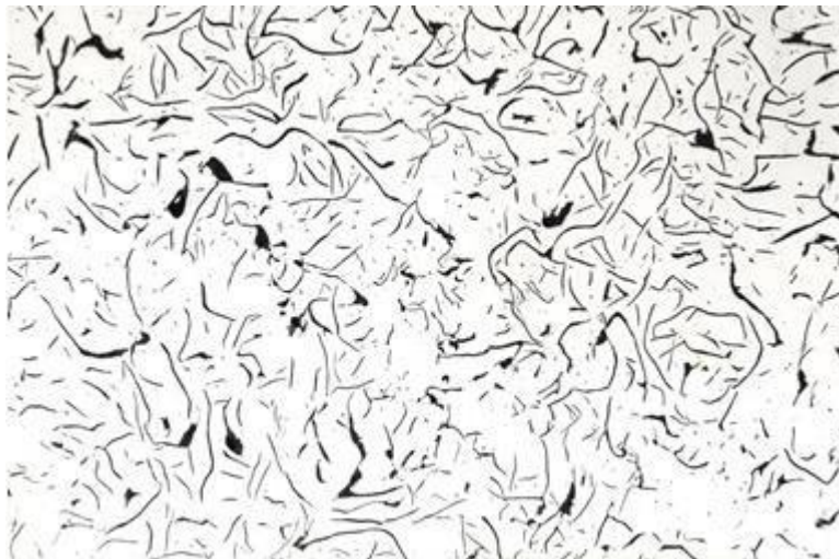
Figure I. 3: Microstructure d'une Fonte à graphite lamellaire. [7]
