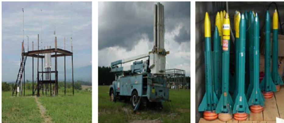
Figure I.8. Lanceurs et fusées utilisés lors d'un déclenchement artificiel de la foudre (a) lanceur fixe, (b) lanceur mobile et (c) fusées [14].
