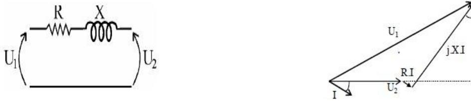
Figure II.1 : modèle réduit et représentation vectorielle
