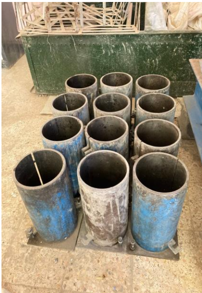
Coffrage de Epreuve cylindrique 16/32 (a)
