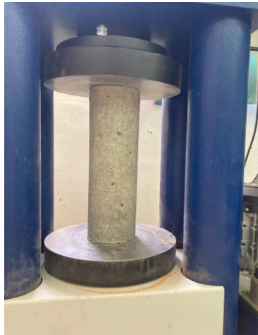
éprouvettes cylindrique 11/33 en béton ordinaire
