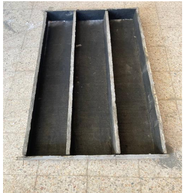
Coffrage de poutre 10x20x120 (e)
