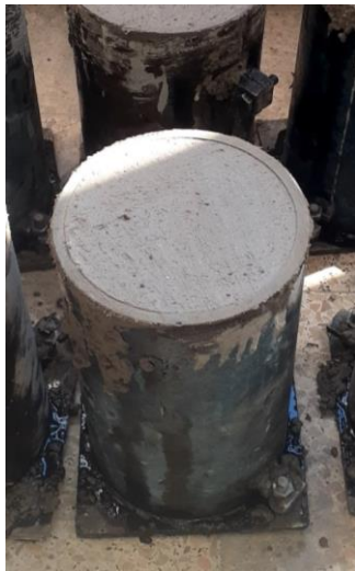
Remplissage éprouvette 16/32(a)
