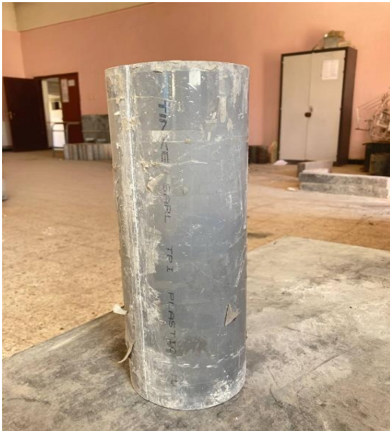
Coffrage de Epreuve cylindrique PVC 11/33 (d)
