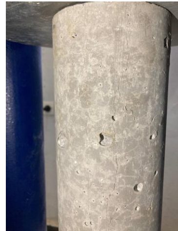
Fissuration sur éprouvette 11/33
