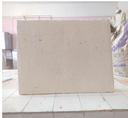
L'élément sandwich après le collage
