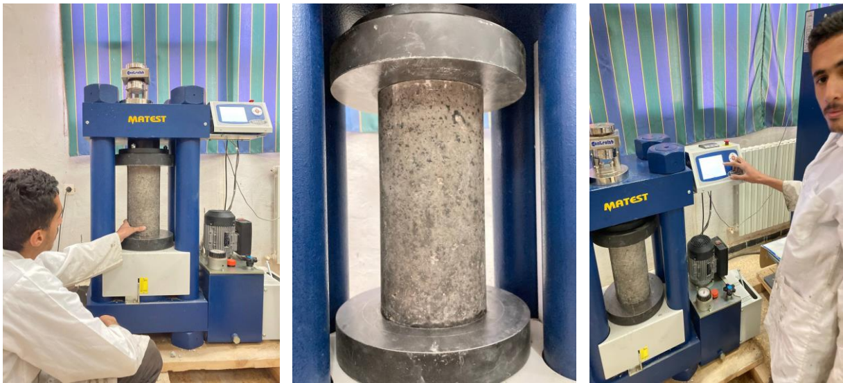
Figure III-22 – Essais d'écrasement sur éprouvette 16/32
