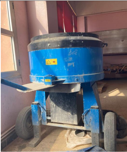
bétonnières de capacité 200 l (a)
