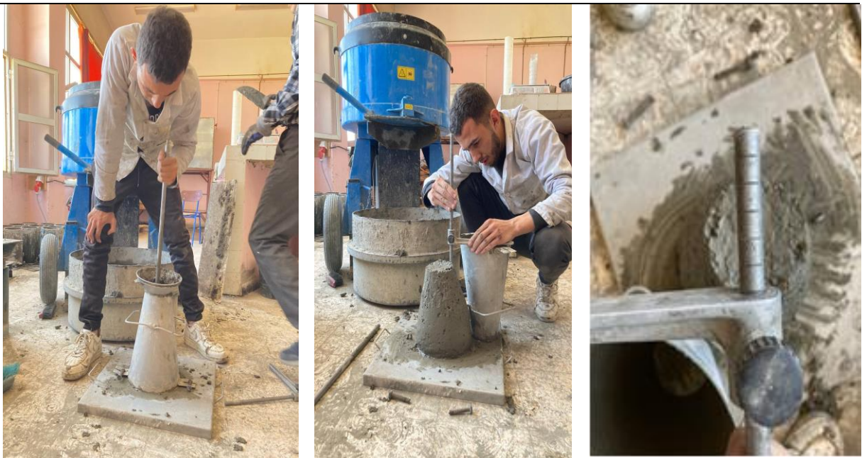
Remplissage de Cône d'Abrams (a)
