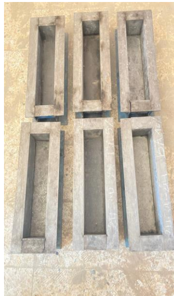
Coffrage de poutre 10x10x40 (b)
