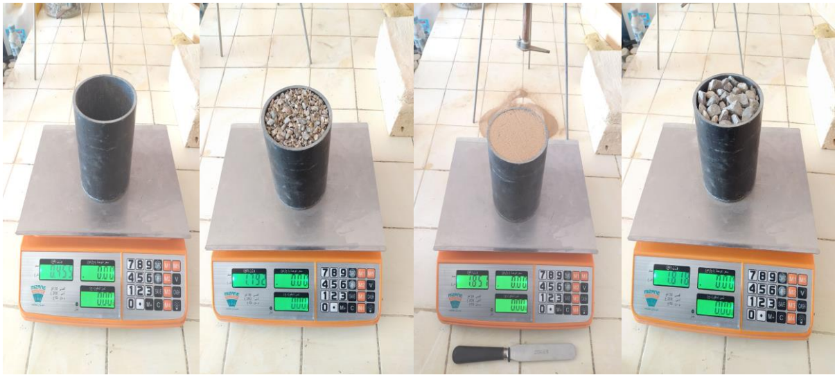
Figure III-1 - Mesure des masses volumiques pour les trois matériaux composant le béton
