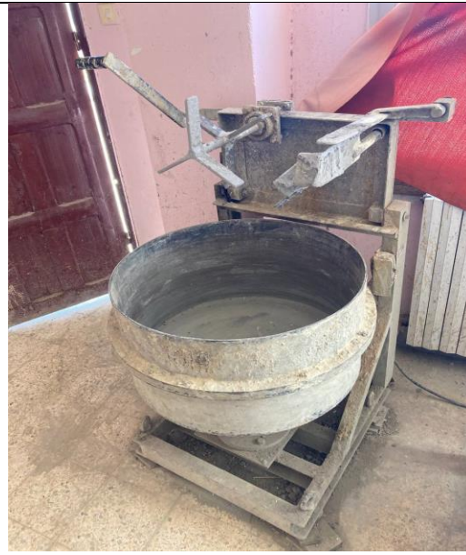
bétonnières de capacité 100l (b)
