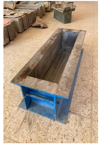
Coffrage de poutre 10x15x80(c)
