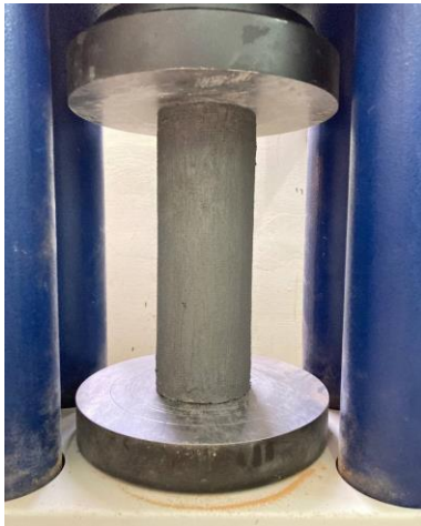
éprouvettes cylindrique 11/33 en béton avec un confinement en fibre verre,
