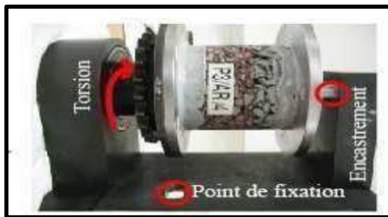
Figure III.3: Dispositif d'essai torsion en laboratoire
