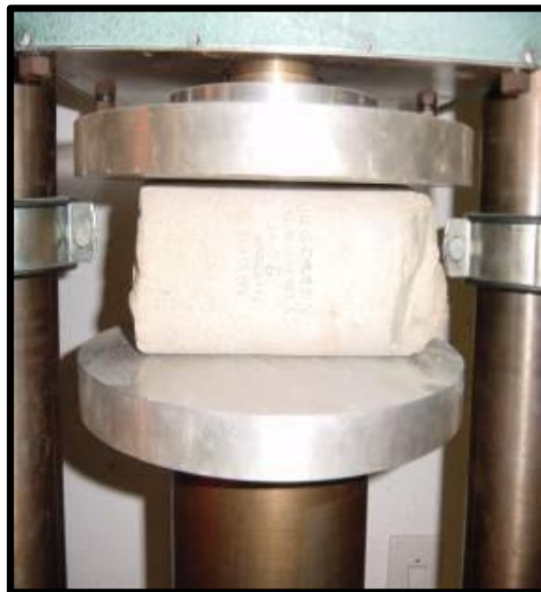
Figure III.7: Dispositif de résistance en traction par fendage
