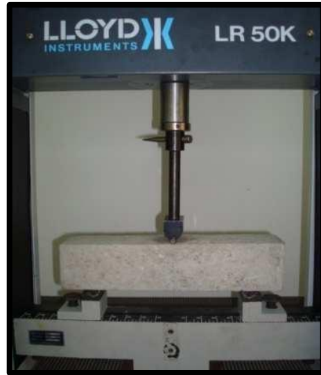
Figure III.6 : Dispositif d'essai de flexion 3 points
