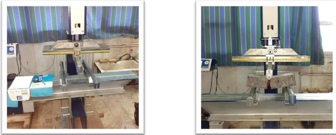
**Figure III- 27:** Essai de traction par flexion des éprouvettes prismatiques (10x10x40) cm<sup>3</sup> (trois points)
