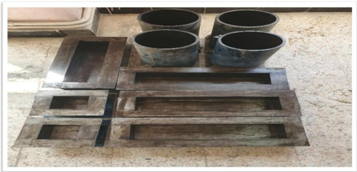
**Figure III-17:** Eprouvettes utilisées (cylindriques 16x32cm<sup>2</sup>, cubiques 10x10x10 cm<sup>3</sup> et prismatique 10x10x40 cm<sup>3</sup>)
