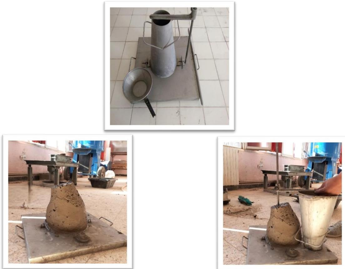
**Figure III-20:** Affaissement au cône d'Abrams
