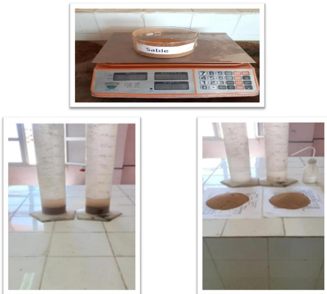
**Figure III-6:** Détermination de la masse volumique absolue de sable
