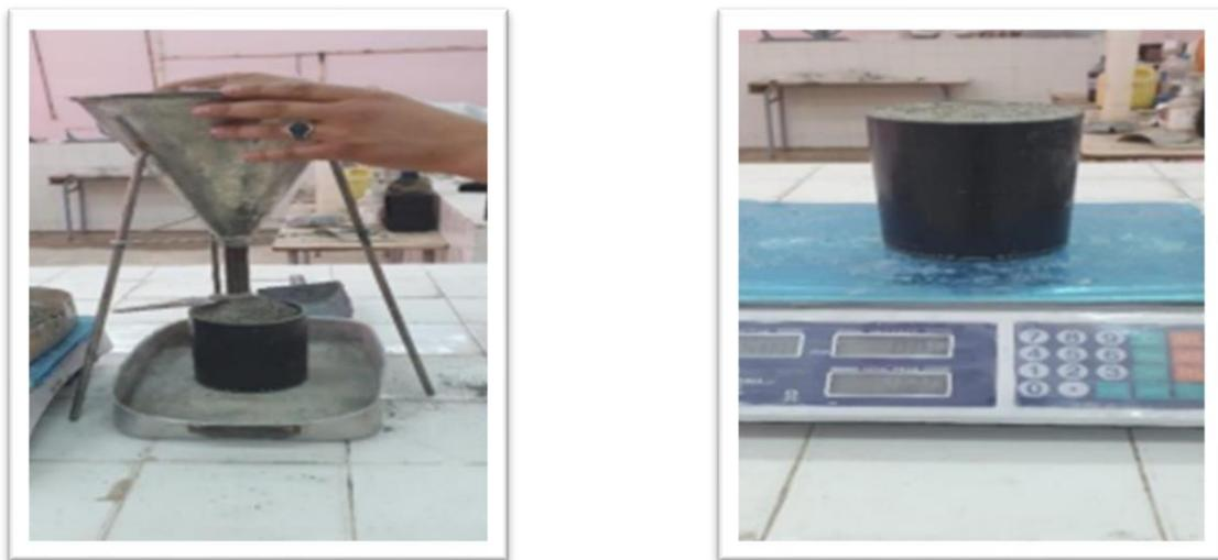
**Figure III-10:** Détermination de la masse volumique apparente de ciment
