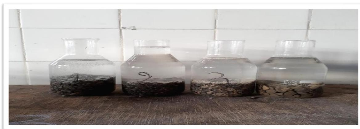
**Figure II-6:** Absorption des granulats recyclés en fonction de temps
