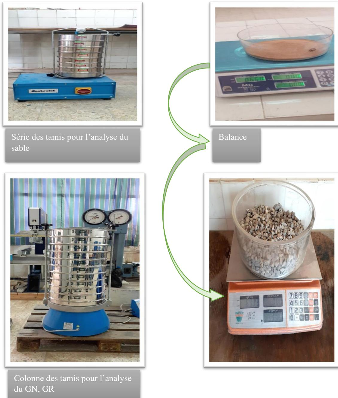
**Figure III-11:** Essai de l'analyse granulométrique de sable et GN,GR
