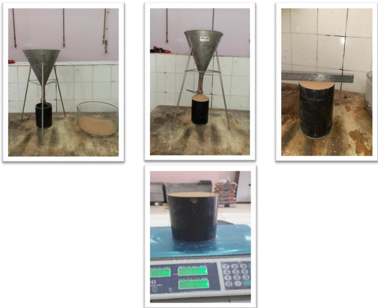
**Figure III-8:** Détermination de la masse volumiques apparente de sable
