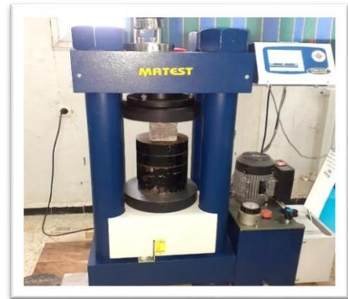
**Figure III-24:** Essais de compression des éprouvettes cylindriques (16x32) cm<sup>2</sup> et cubiques (10x10x10) cm<sup>3</sup> des bétons BO et BR
