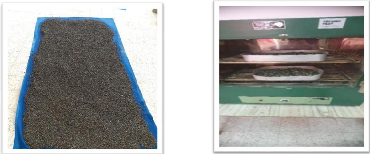
**Figure III-2:** Préparation de gravier naturel (lavage et séchage)
