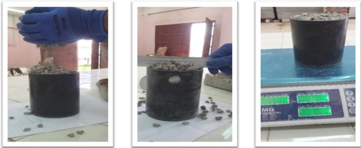
**Figure III-9:** Détermination des masses volumiques apparentes (GN, GBR)
