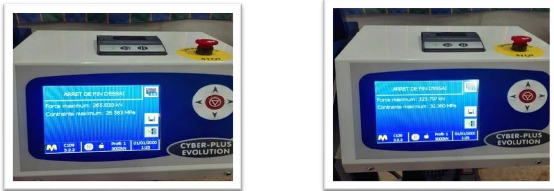
Figure III-25: Résultats de l'essai de compression
