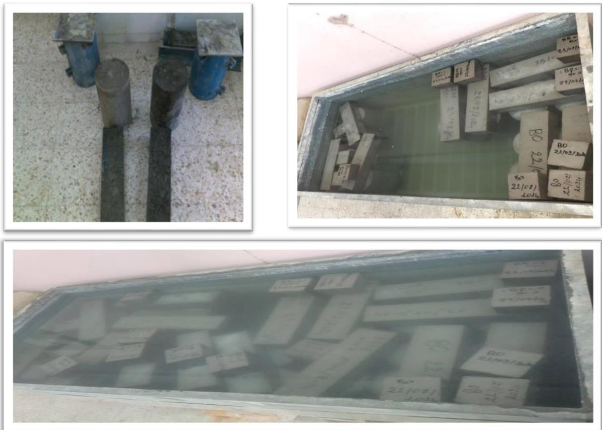
**Figure III-23:** Démoulage et conservation des éprouvettes cylindriques, prismatiques et cubiques
