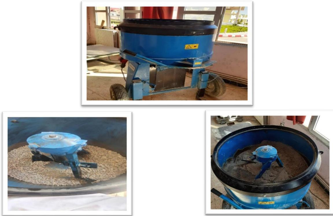
**Figure III-19:** Malaxage de béton à l'aide d'une bétonnière
