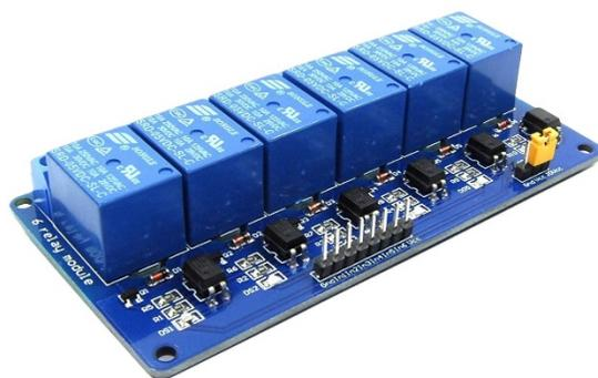
**Figure III.11:** Module de relais à 6 canaux.
