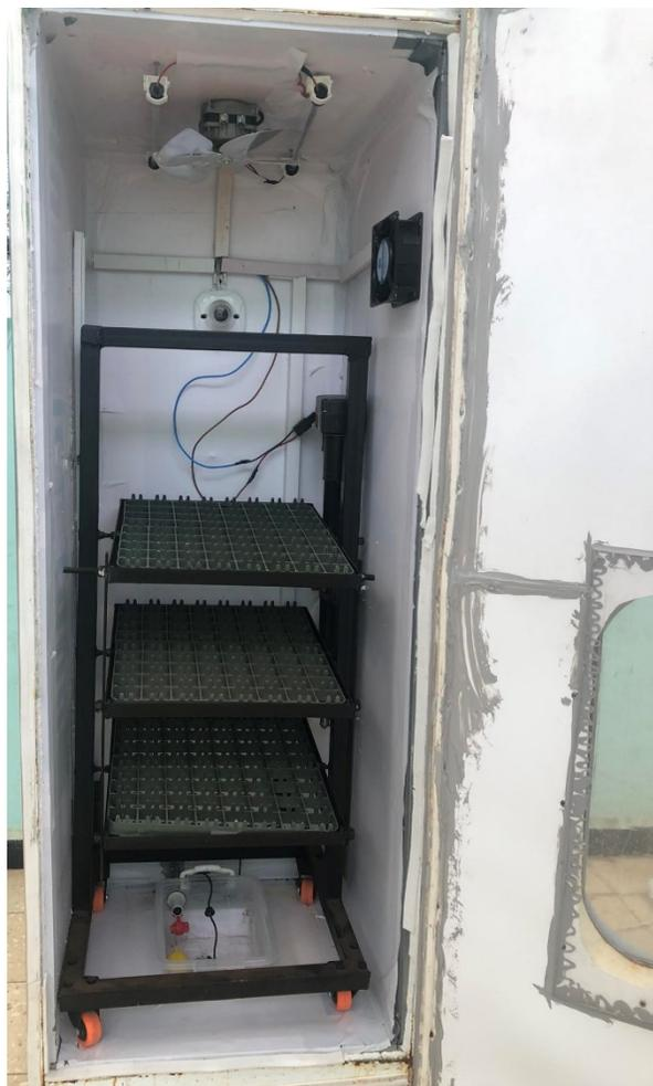
**Figure IV.1:** La photo montre l'intérieur de la couveuse, y compris les composants de contrôle environnemental et le mécanisme de retournement.
