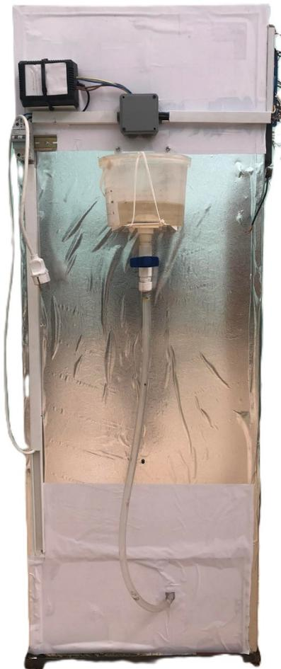
**Figure IV.3:**La photo montre l'arrière de la couveuse où se trouve le circuit d'alimentation et le réservoir d'eau secondaire.
