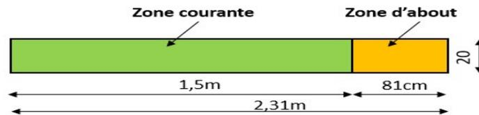
**Figure VI .5 :** Vue en plan d'un voile en béton armé (Zone tendue)
