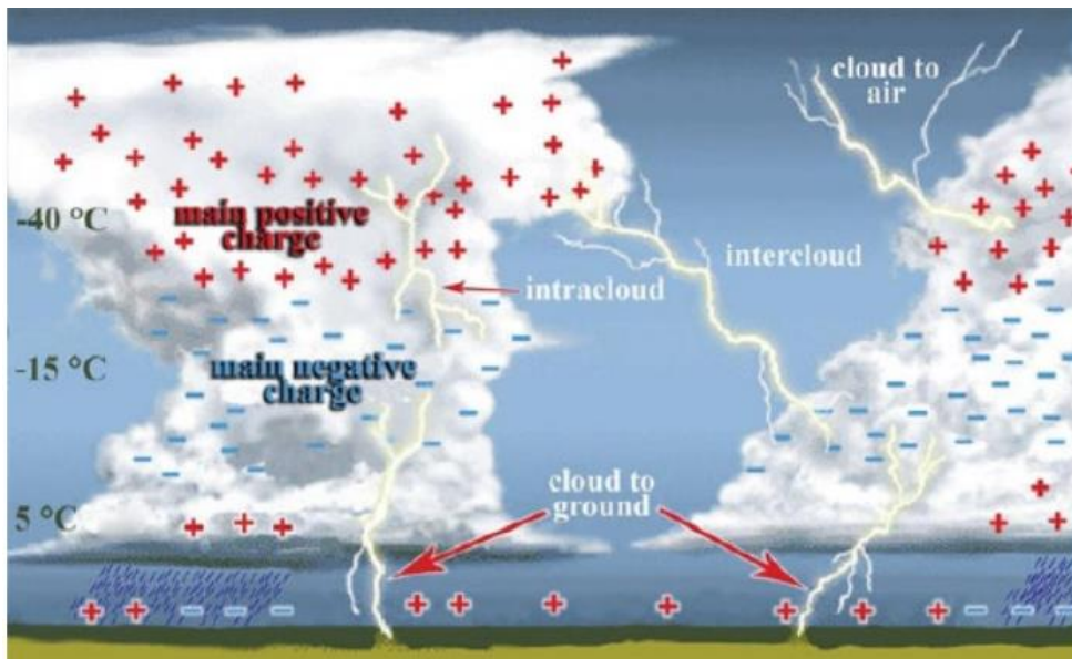
Figure. I.2. La structure de charge de deux nuages d'orage isolés simples et certains des endroits où la foudre peut se produire. [5]
