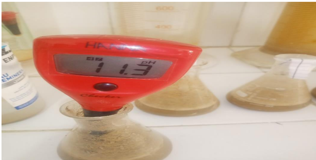
Figure III.6: Mesure de pH du sol par pH-mètre
