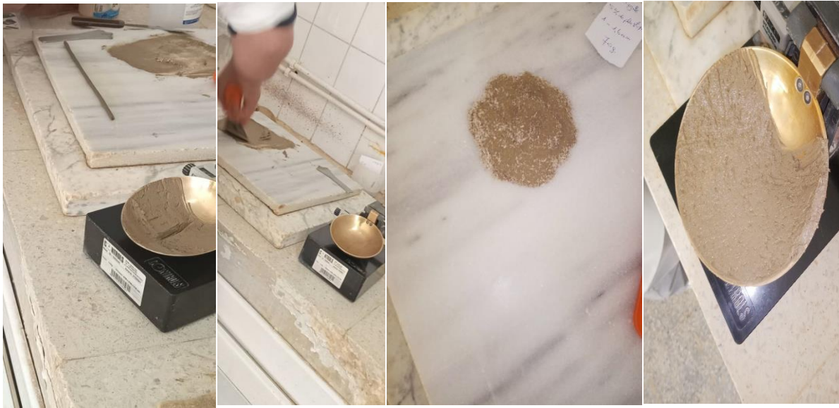
Figure III.8: Appareillage de limites d'Atterberg.
