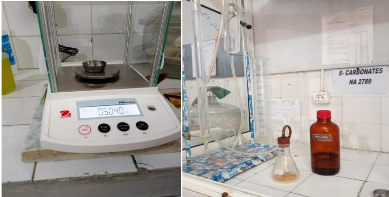
Figure. III.1 : Appareil de l'Essai d'évaluation de carbonates
