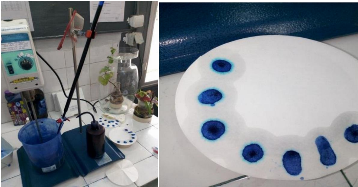
Figure. III.2 : Les étapes de l'essai de bleu de méthylène
