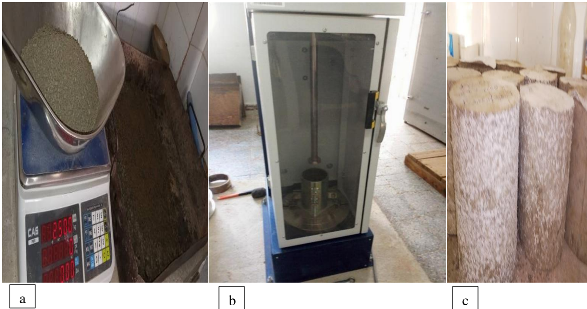
Figure III.9 : Etapes de réalisation de l'essai Proctor : (a) balance pour peser du matériau ; (b) dame automatique ; (c) éprouvette après démoulage.
