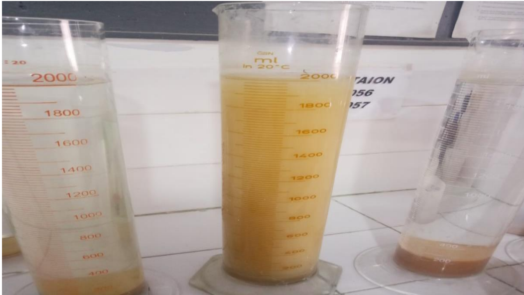
Figure III.5: Appareillage d'analyse granulométrique par sédimentométrie
