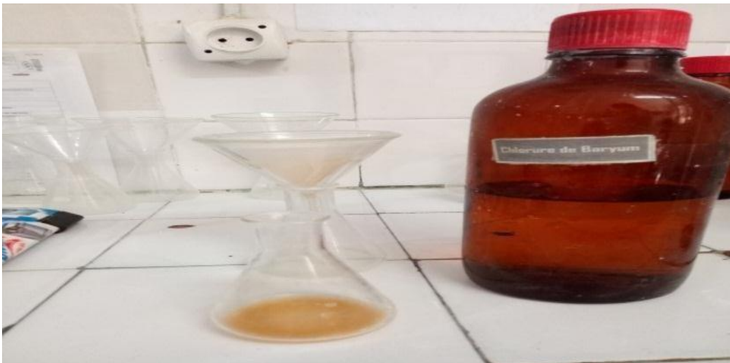
Figure III.3: Dispositif d'essai de la teneur en sulfates
