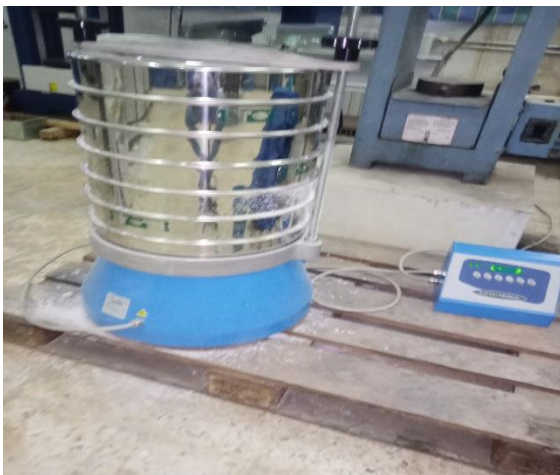
Figure III.4: série de tamis pour L'essai granulométrie par tamisage
