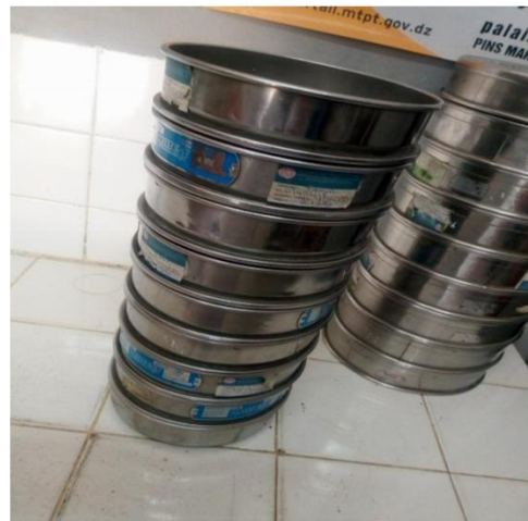
Figure III.4: série de tamis pour L'essai granulométrie par tamisage
