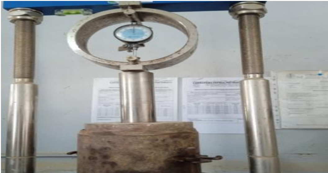
Figure III.10 : Essai de Poinçonnement à la Presse CBR.
