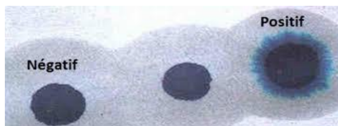
Figure 4.31 : Vérification de l'activité du sol.
