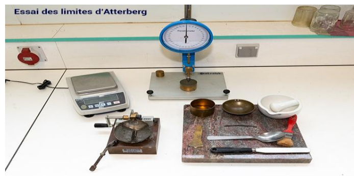
Figure 4. 17 : Equipements utilisés dans l'essai des limites d'Atterberg.
