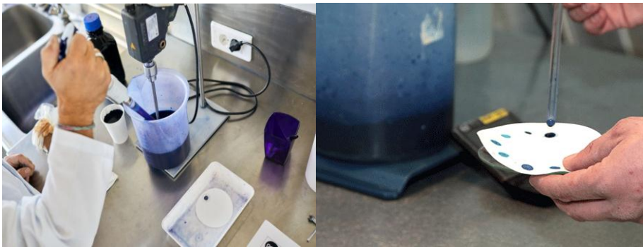
Figure 4.30 : Prélèvement d'une goutte de suspension et la déposer sur le papier filtre.
