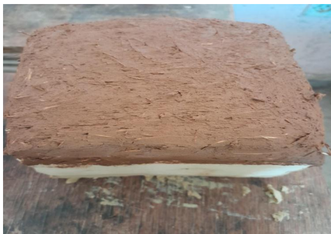
Figure 4.44. Enduit (fibre de paille)
