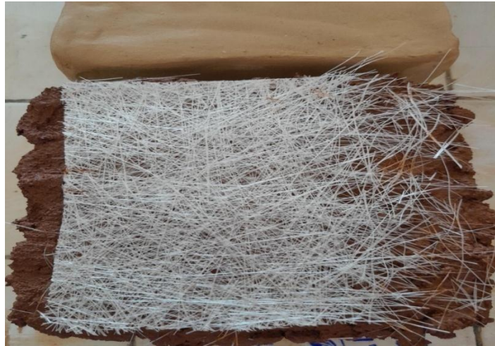
Figure 4.42. + Enduit (fibre de verre surfacique) .
