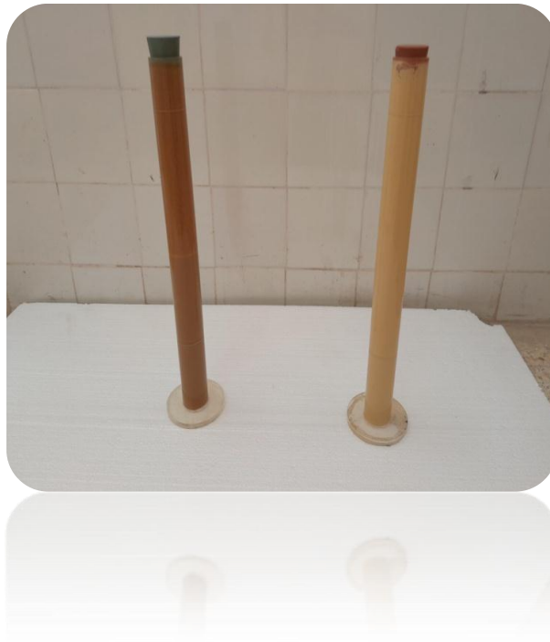
Figure 4.26. Processus de décantation.
