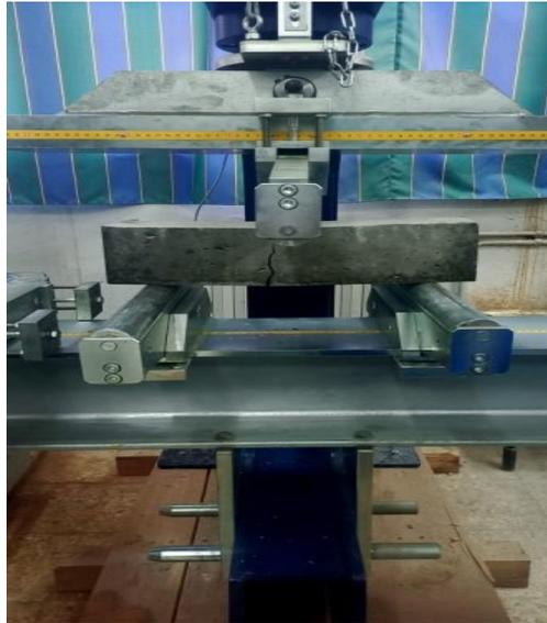
**Figure III.28:** Machine pour essai de traction par flexion.
