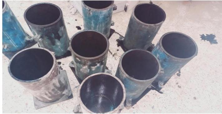
Figure III.21: Préparation d'éprouvette cylindrique (Labo de génie civil TIARET).
