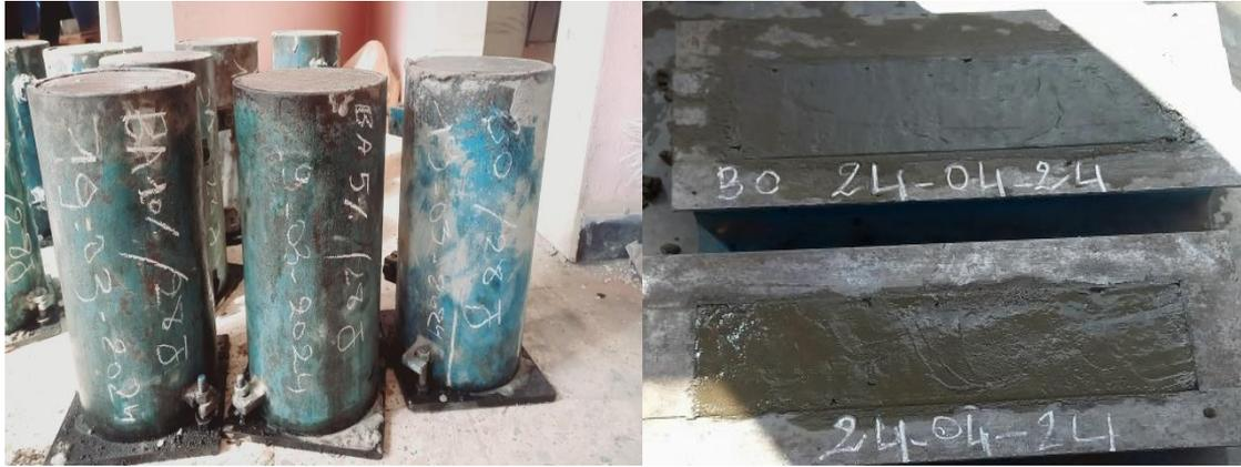
Figure III.24: Moulage des éprouvettes cylindriques et prismatiques.
