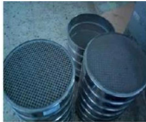
**Figure I.3:** Série des Tamis en (mm)
