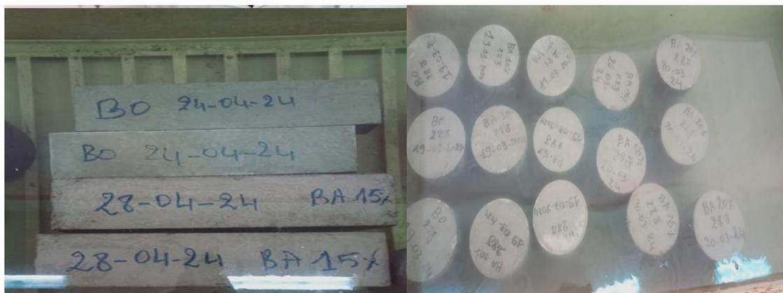
Figure III.25: Conservation des éprouvettes (cylindriques et prismatiques).
