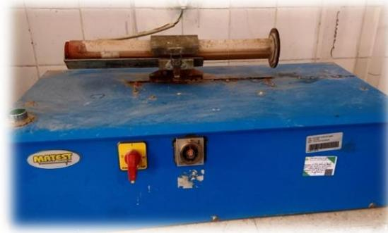
Figure III.10: Machine d'agitation (mouvement rectiligne horizontal).
