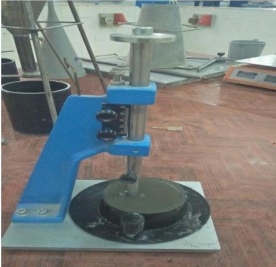
**Figure III.4:** Appareil de Vicat.
