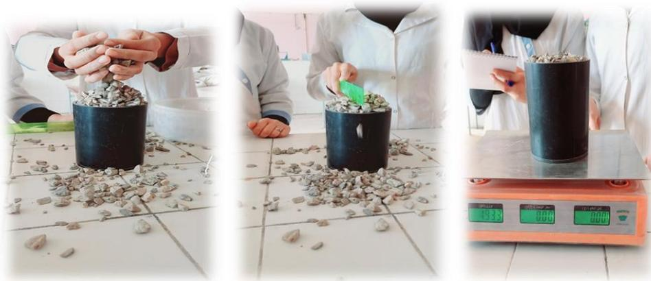
Figure III.13: Essai de la masse volumique du gravier 8/15.
