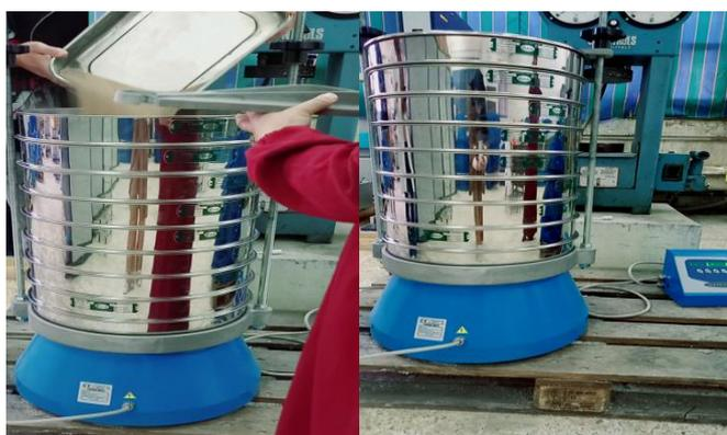
Figure III.7: Essai de l'analyse granulométrique du sable.
