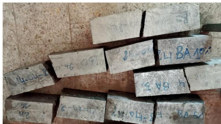
**Figure IV.2:** Éprouvettes prismatique conservées pendant 28 jours.
