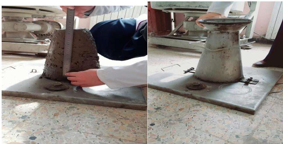
**Figure III.23:** Affaissement au cône d'Abrams.
