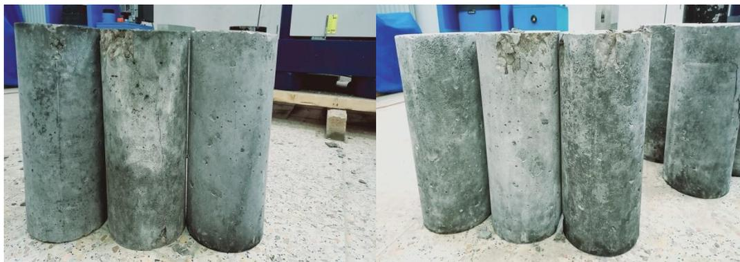
**Figure IV.1:** Éprouvettes cylindriques conservées pendant 28 jours.
