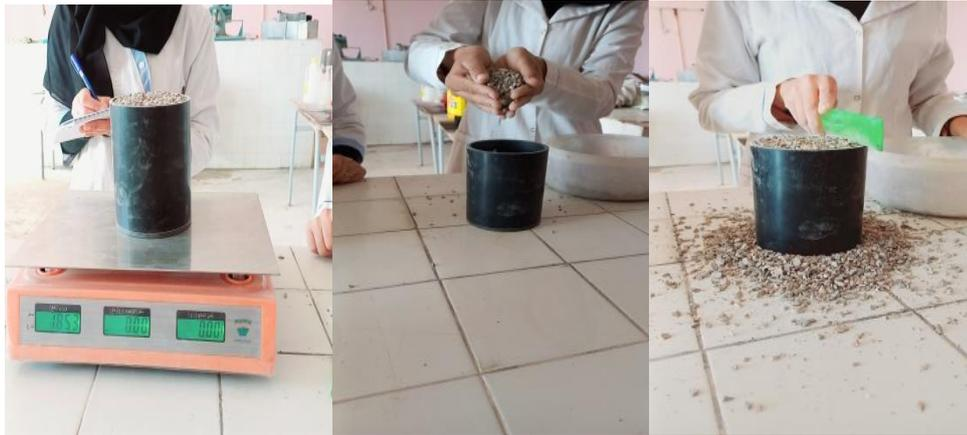
Figure III.12: Essai de la masse volumique du gravier 3/8.
