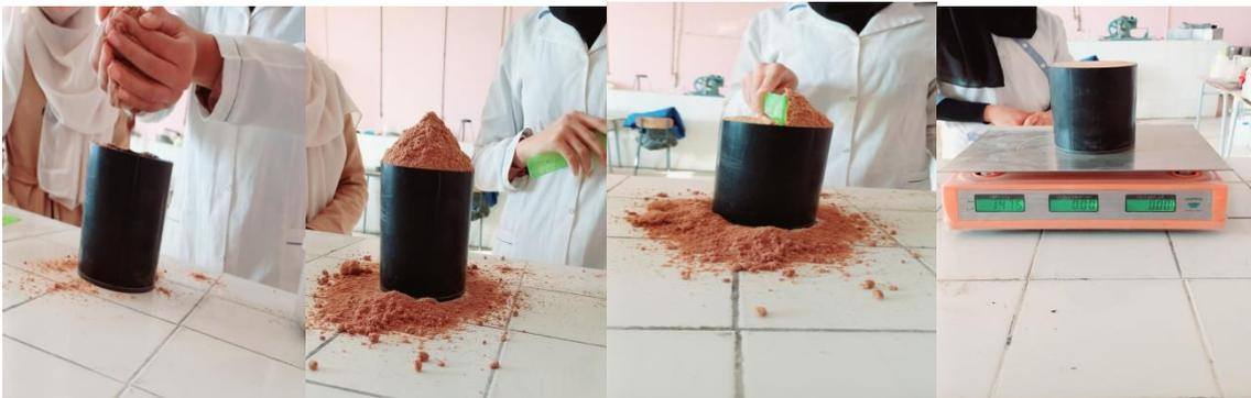
Figure III.5: La masse volumique apparente (labo de génie civil).
