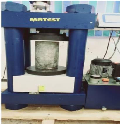
Figure III.26: Machine pour essai de compression simple.
