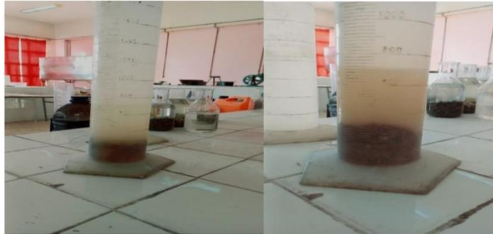
**Figure III.14:** Éprouvette pour l’essai de l’équivalent du gravier 3/8 et 8/15.
