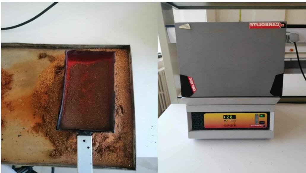
**Figure III.18:** La calcination de l'argile.
