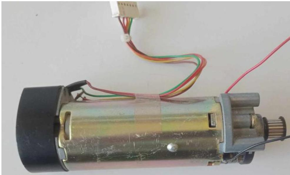
Figure IV. 6 moteur à courant continu
