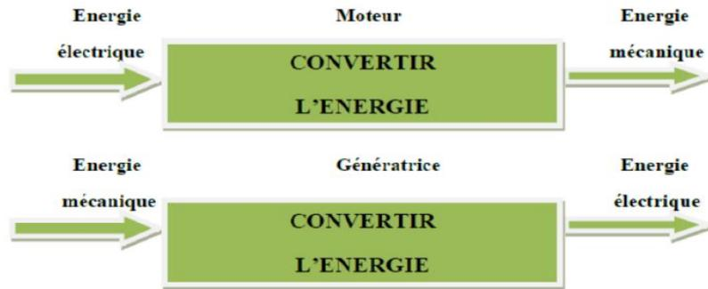
Figure I. 1 Conversion d'énergie de la machine à courant continu [3]
