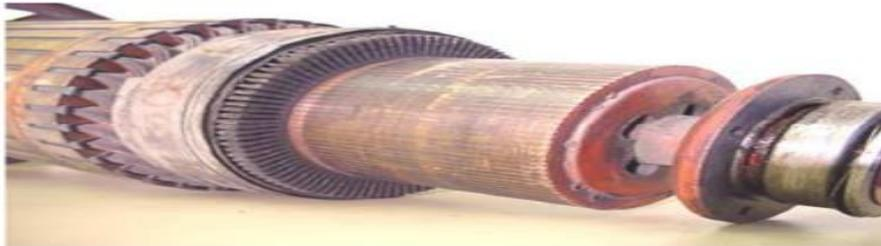
*Figure I. 5 collecteur de la machine à courant continu [4]*
