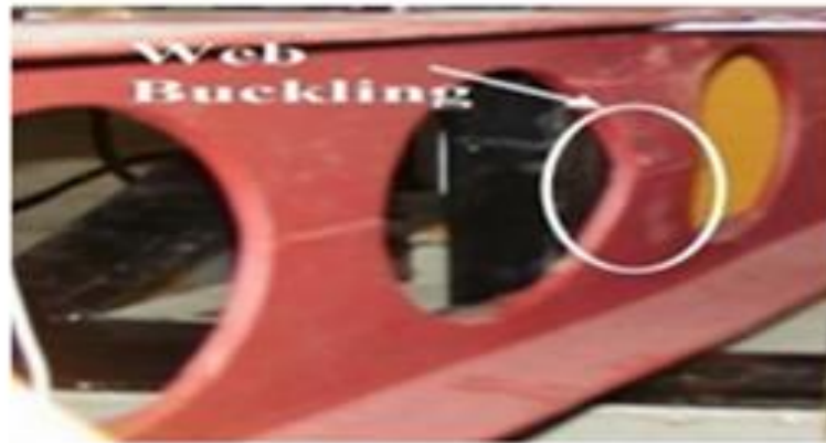
Figure 13: Flambement du montant d'âme sous compression [4].
