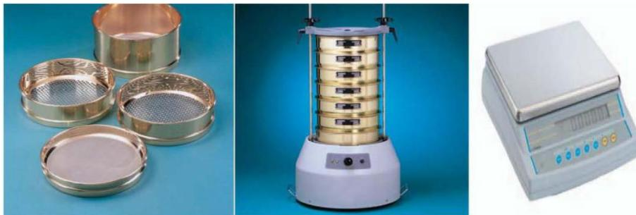
**Figure 4.2:** Matériel utilisé dans l'analyse granulométrique
