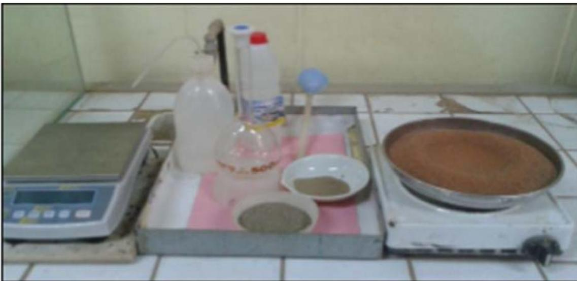
**Figure 4.5:** Essai au pycnomètre
