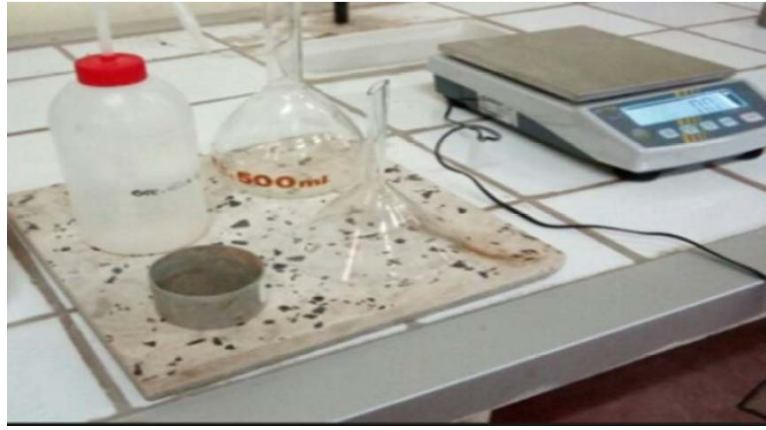
Figure 3.6: Matériels utilisés dans l'exécution des essais au pycnomètre.
