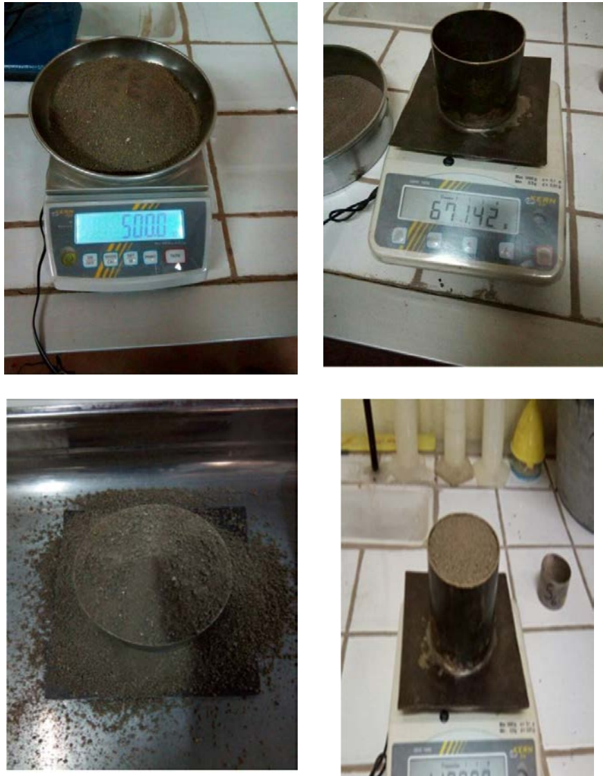
Figure 3.9: Exécution des essais de l'indice des vides maximal ( e_{\max} )
