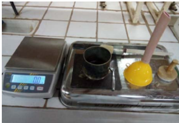
Figure 3.8: Matériels utilisés dans l'exécution des essais de l'indice des vides maximal ( e_{\max} )
