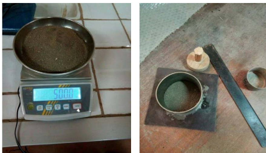
Figure 3.10: Matériels utilisés dans l'exécution des essais de l'indice des vides minimal ( e_{\min} )
