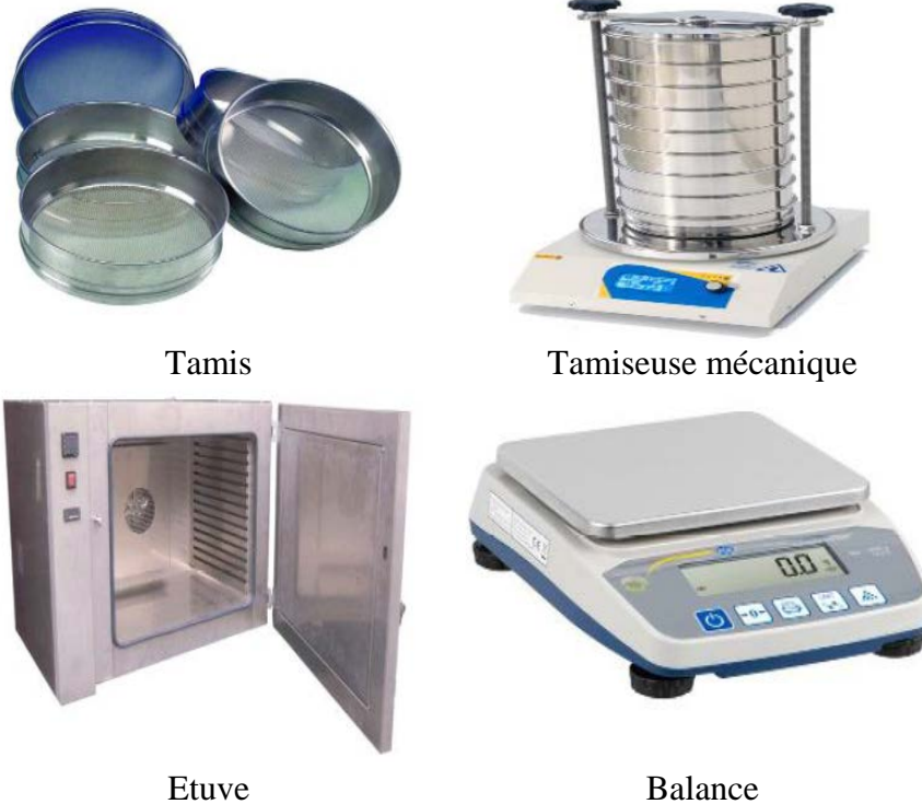
Figure 3.3: Matériels utilisés dans l'analyse granulométrique.
