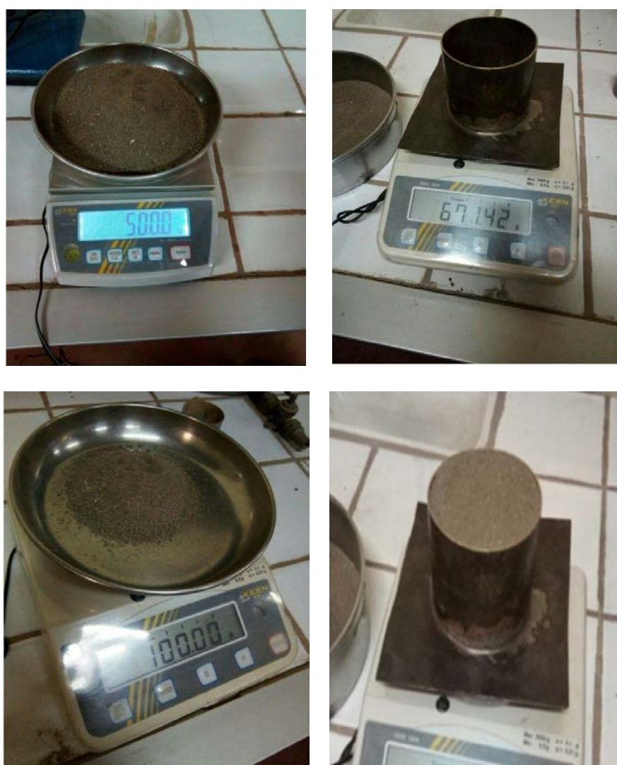
Figure 3.11: Exécution des essais de l'indice des vides maximal ( e_{\max} )
