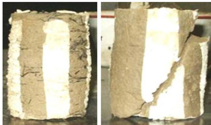
Figure 2.5: Modèle de déformation des échantillons pour les échantillons de sol argileux non renforcés (à gauche) et pour les sols argileux renforcés (à droite) avec 0.25% de PP de 19 mm (Setty et Murthy 1987).
