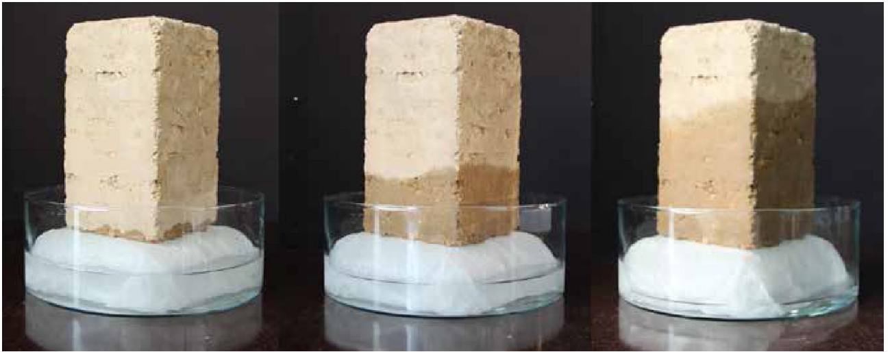
Figure 2.6 dispositif expérimental de l'essai d'absorption capillaire[29]
