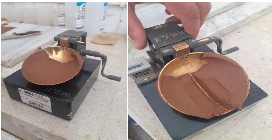
Figure : 4.7 la limite de liquidité
