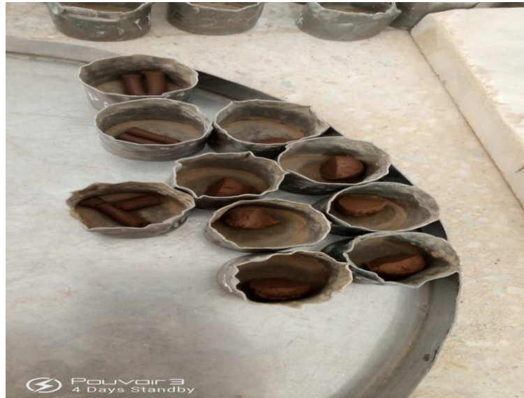
Figure 4.8 : la limite de plasticité
