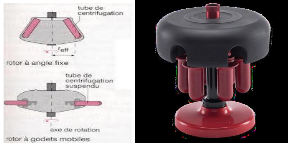
Figure 17 : Rotor à godet mobile et à angle fixe
