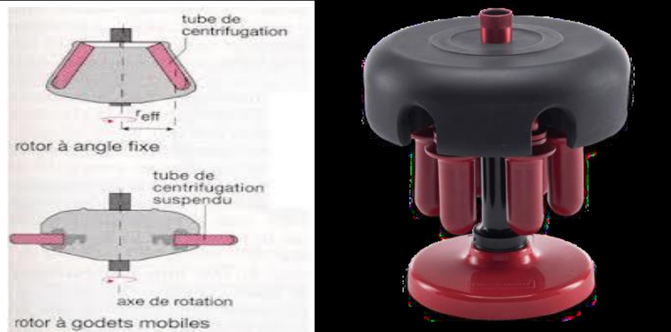
Figure 7 : Rotor à godet mobile et à angle fixe
