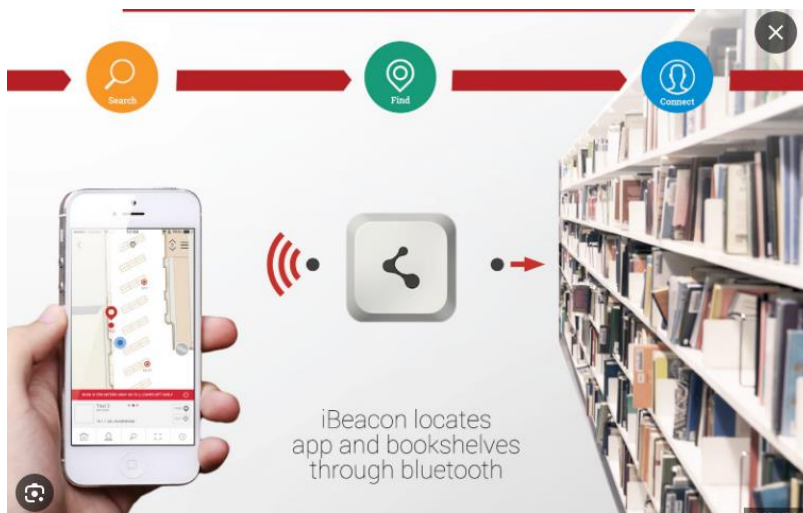
الملحق 36: يوضح طريقة تواصل المرشد اللاسلكي مع جهاز المستخدم داخل المكتبة
