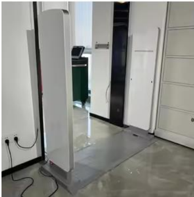
الملحق 07: جهاز قارئ Rfid على شكل بوابة مرور
