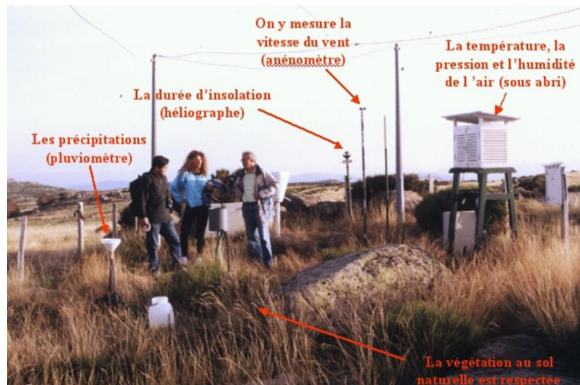
Figure III 12. Station climatique en montagne (CNRS Mont Lozère, 2003)
