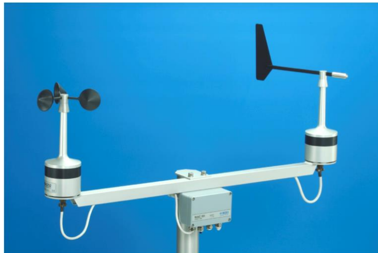
Figure IV 9. Anémomètre girouette et enregistreur
