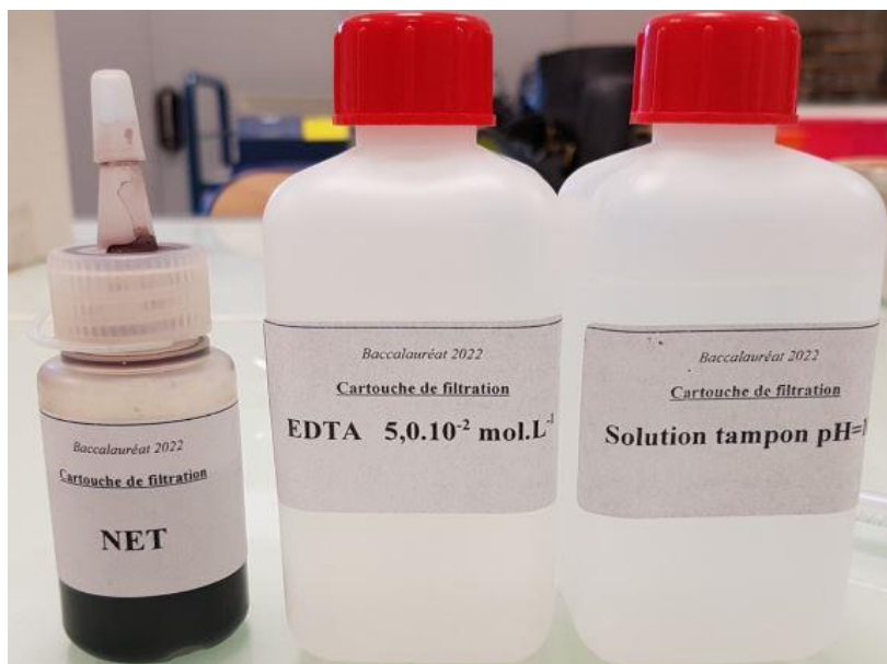
Figure II 12. Colorant et réactif utilisés pour la détermination de la dureté
