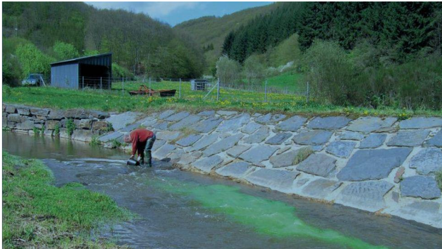
Figure V 1. Jaugeage par dilution (Laborde, 2000)
