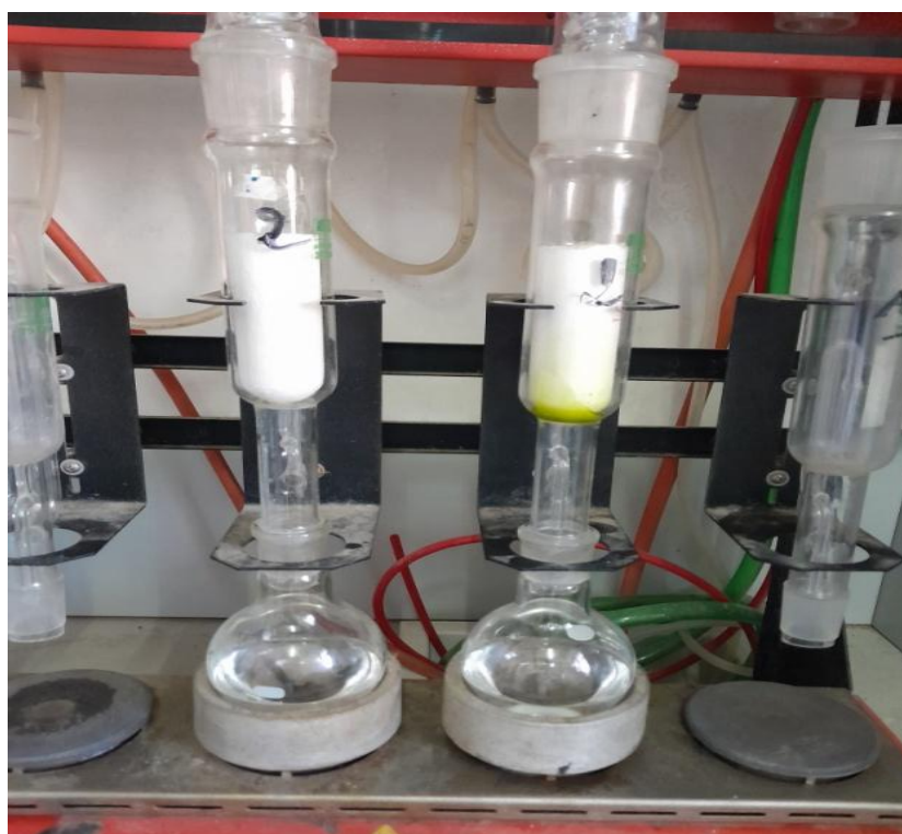
Figure N°22: Photo d'extracteur Soxhlet (originale, 2023).
