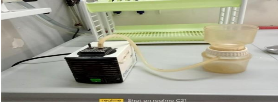
Figure 15 : Appareil de dosage MES (Photo originale)
