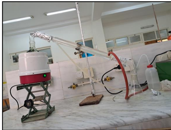
Figure II. 5: Dispositif expérimental d'extraction par hydrodistillation (prise par nous-mêmes).
