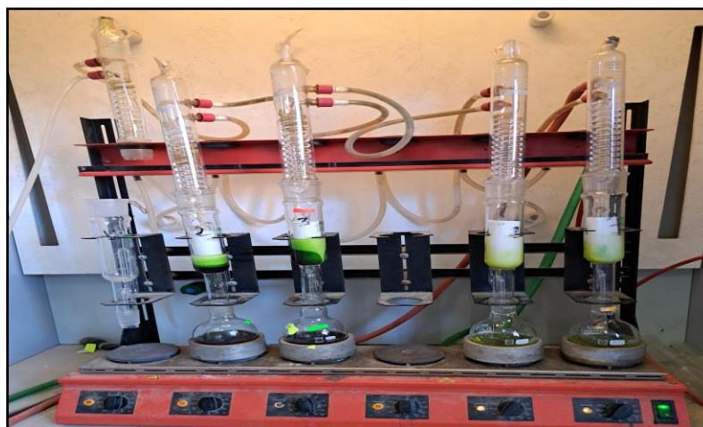
Figure II. 3 : Dispositif expérimental d'extraction par Soxhlet (prise par nous-même).
