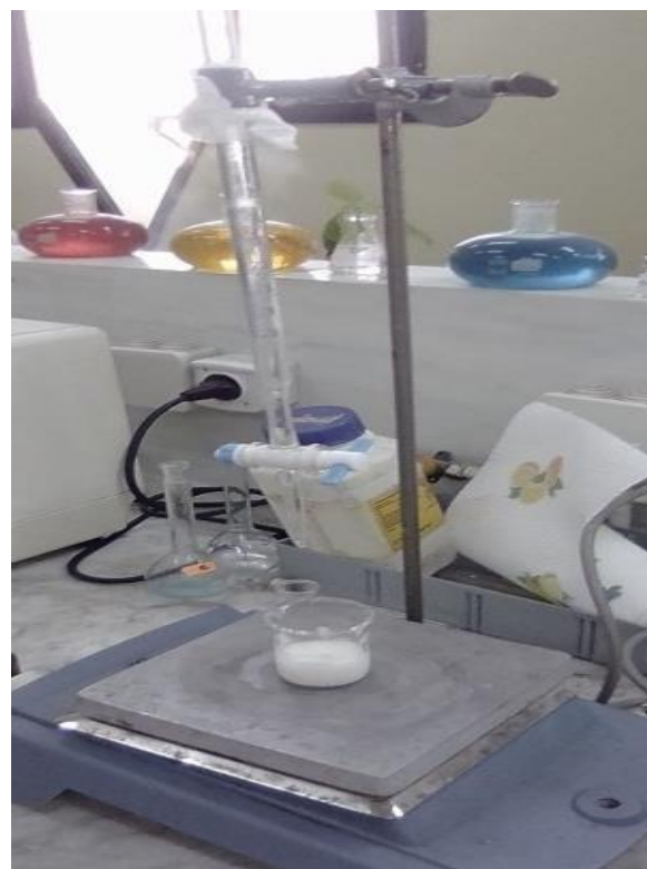
Titratable acidity apparatus
