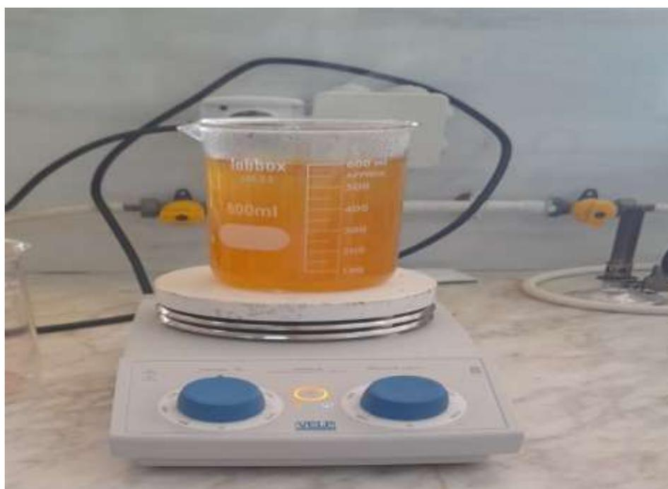
**Photo n°02 :** Agitateur à plaque chauffante (photo originale).
