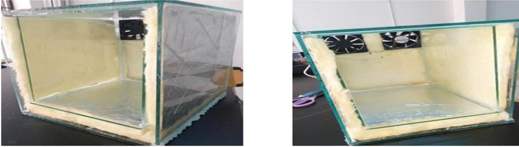
*Figure II. 2:* Fixation de ventilateur et l'isolant thermique
