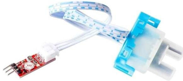
*Figure I. 6:* Capteur de turbidité
