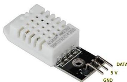
**Figure I. 5:** Capteur DHT22
