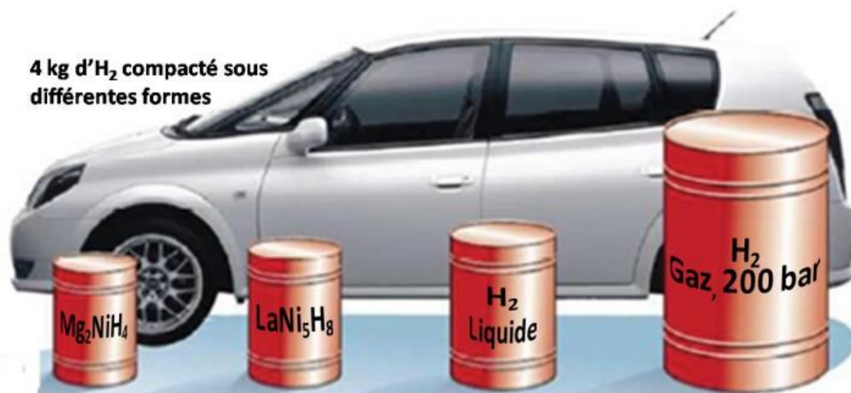
Figure I.17: volume d'une masse d'hydrogène compacté par différentes techniques, comparé à une voiture réelle (Source : Toyota Press Information, 33rd salon de l'automobile, 1990).
