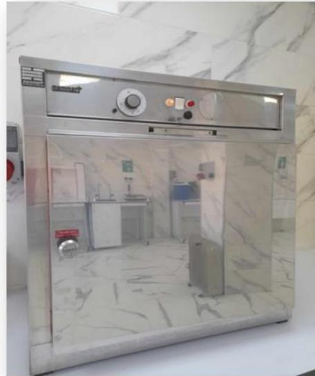
**Photo 17:** Etuve réglable à  $30^{\circ}\text{C} \pm 1^{\circ}\text{C}$  et à  $25^{\circ}\text{C} \pm 1^{\circ}\text{C}$
