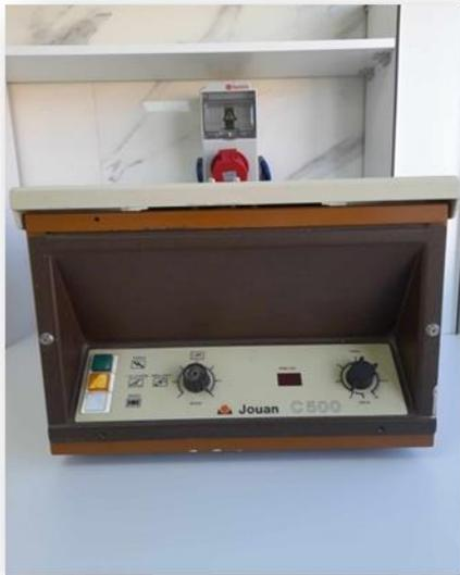
**Photo 16:** Centrifugeuse à une accélération de 2000g.
