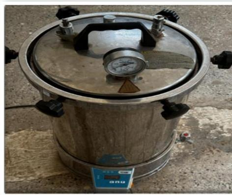
Figure N°22 : Autoclave
