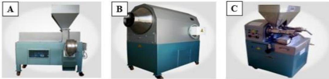
Figure 9: Machines utilisées pour l'extraction par presse mécanique de l'huile d'argan A: Dépulpeuse; B: Torréfacteur à gaz; C: Presseuse de pâte (Charrouf et Guillaume, 2008)
