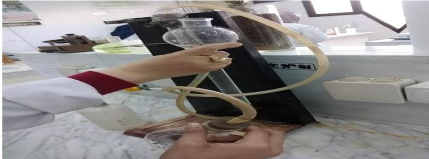
Figure N°8 : Mesure de taux de calcaire
