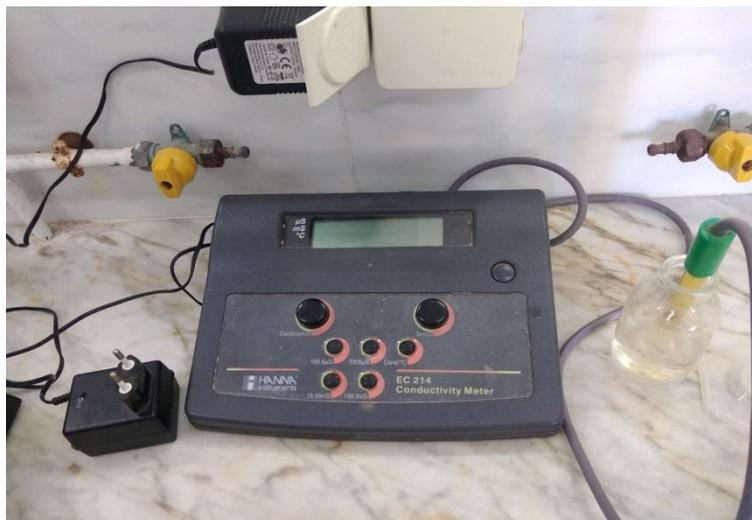
Figure N°9 : Mesure de conductivité
