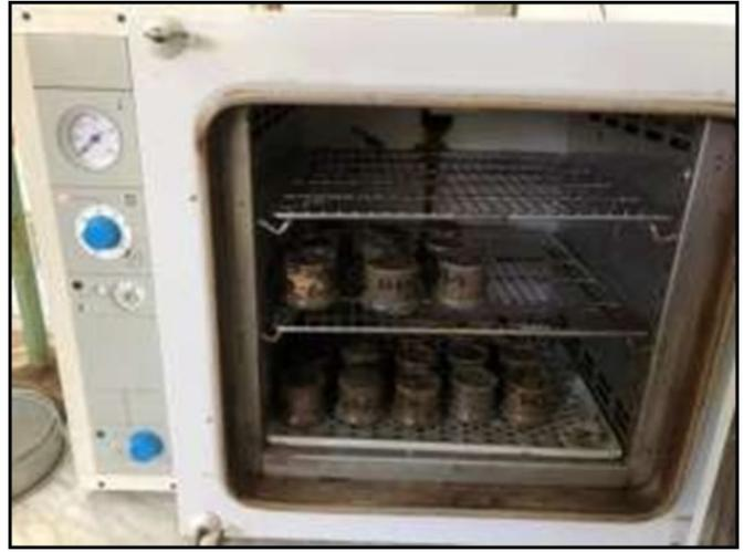
Figure 34. Placement des échantillons dans l'étuve à 105°C
