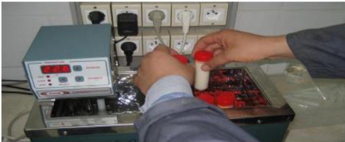
Figure 6 : mettre la semence dans un bain-marie a 22°C (PONTHIER J., VAN DEN BERGHE F, 2014) 31 .
