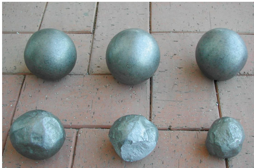
Figure II.7 : Déformations des boulets après un test d'impact
