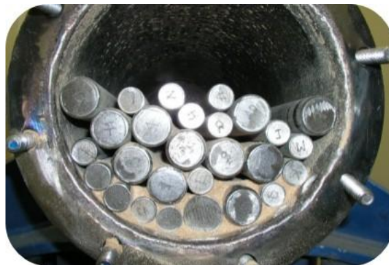
Figure I.2 : Vue intérieure du broyeur à barres
