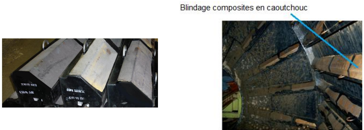
Figure III.4 : Blindages composites en caoutchouc et métal (POLYCORP)
