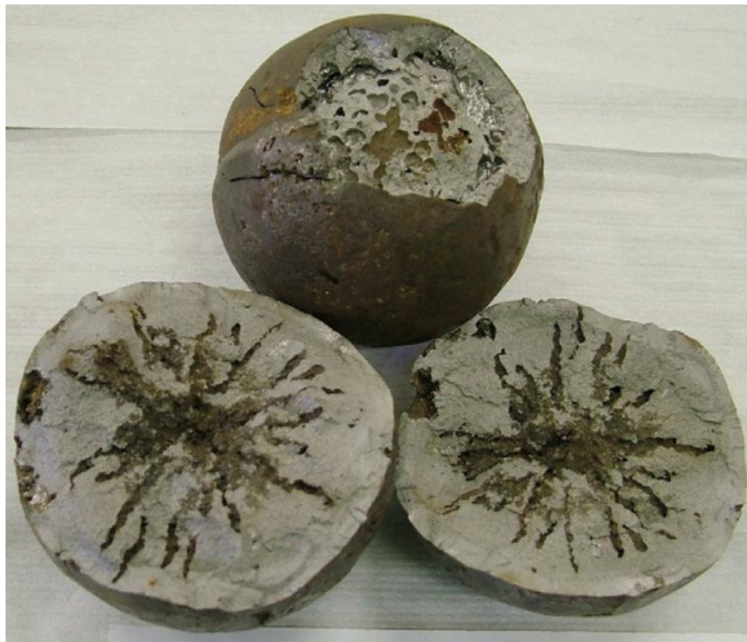
Figure II.6 : Ruptures des boulets après un test d'impact
