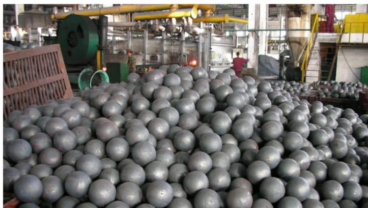
Figure I.6 : boulets de broyage
