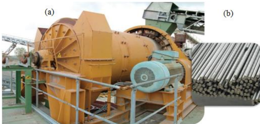
Figure I.1 : (a) Broyeur à barres, (b) Barres en acier haute résistance
