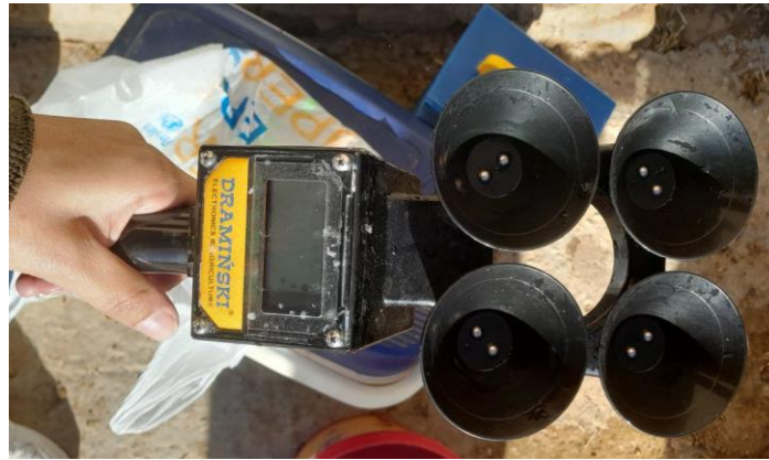
Figure25: Le conductimètre de la marque DRAMINSKI le modèle : 4x4 Q MAST.
