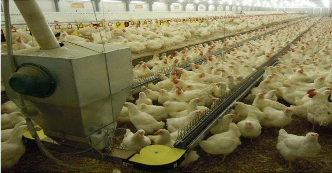
**Figure 3 :** La chaîne plate automatique (sperotto )
