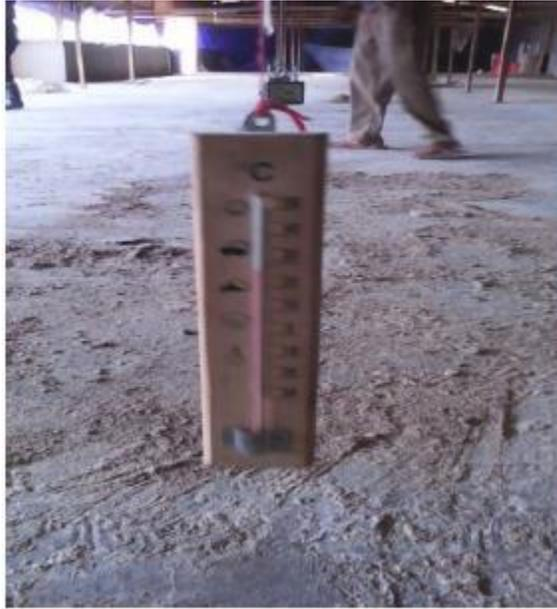
**Figure 35** : Thermomètre positionné à la hauteur de l'aire de vie des animaux (0 – 40 cm)
