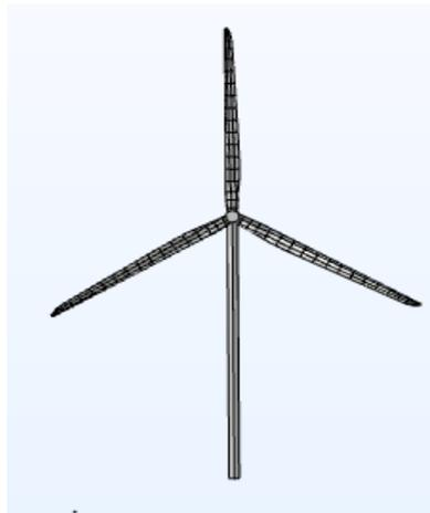
Figure IV-3 Modèle de référence d'une éolienne NREL de 5 MW
