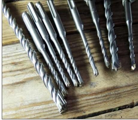
**Figure I.3 :** Outils à arêtes multiples [3].
