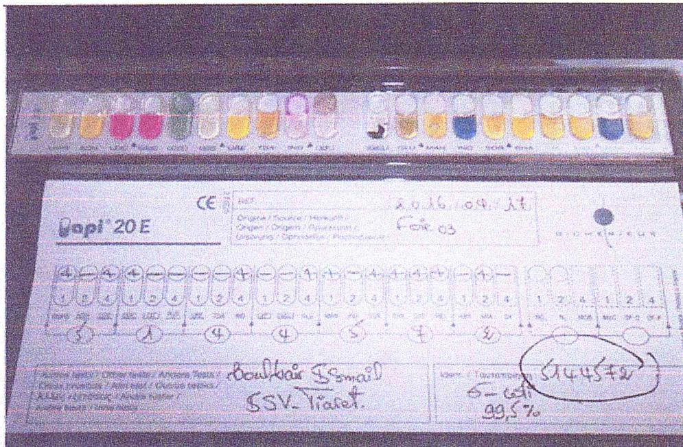
Figure n°17 : exemple d'un profil biochimique d'E. coli sur galerie api 20 E
