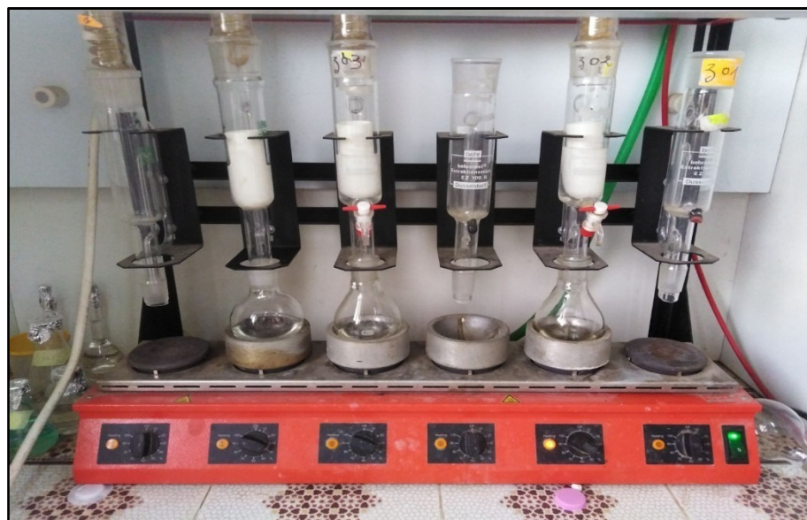
Figure N° 03 : Extraction des lipides au Soxhlet par l'ether de pétrole ( photo originale )
