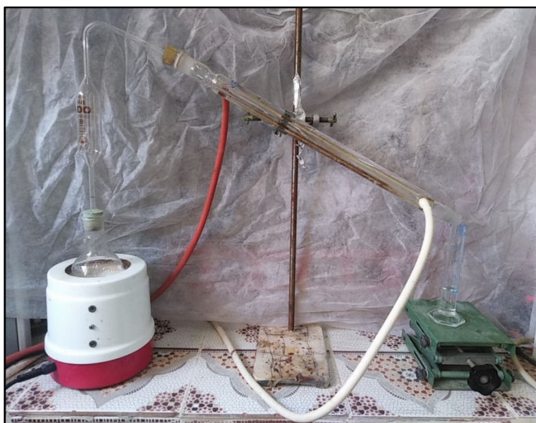
Figure N° 05 : Montage d'entraînement à la vapeur ( Photo originale )
