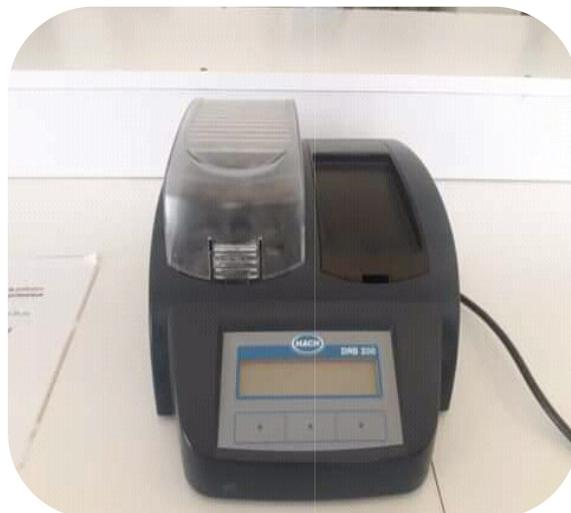
**Figure 4:** photo du digesteur utilisé dans les analyses (photo originale)
