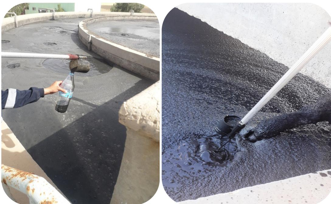
**Figure 2 :** Prélèvement de la boue - Digesteur (*Photo originale*)
