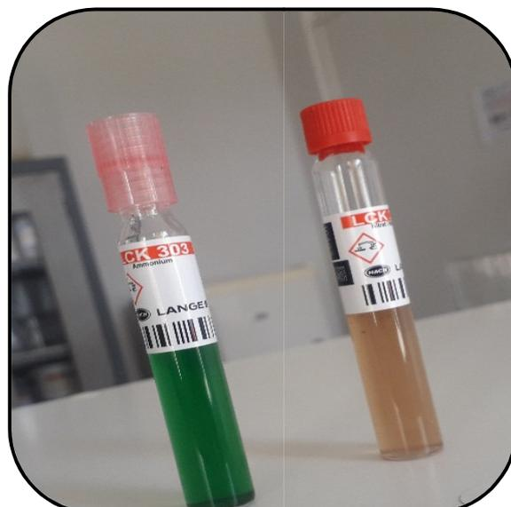
**Figure 6:** Détermination de nitrite et d'ammonium par LCK340 et LCK303 (photo originale)
