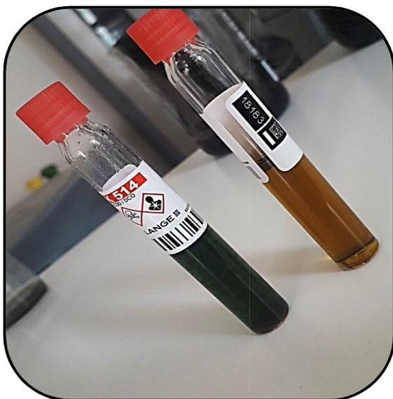
**Figure 5 :** Détermination de DCO et les nitrates par LCK514 et LCK340 (photo originale)
