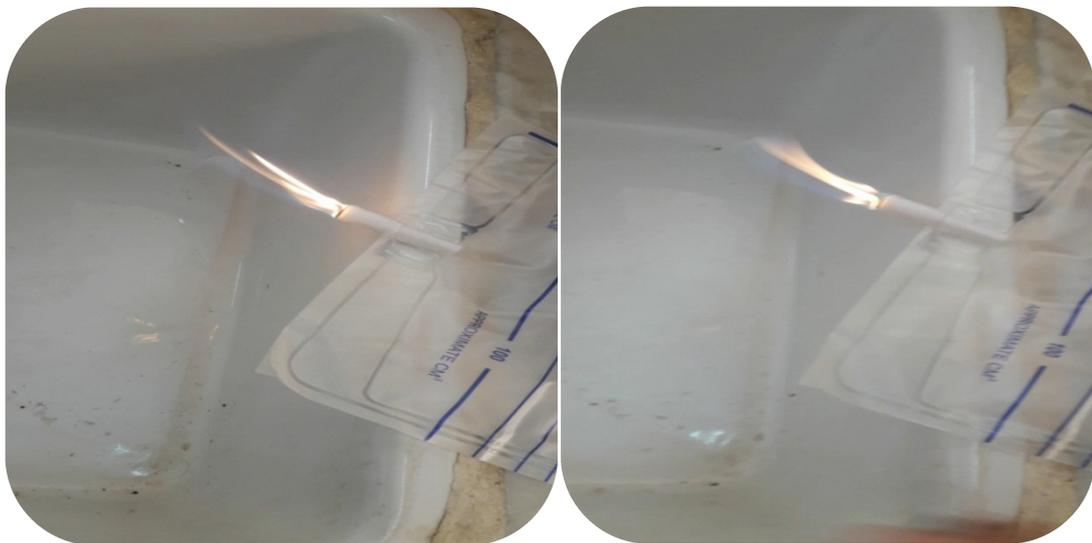
**Figure 8:** Détection de biogaz par le test de flamme (*Photo originale*)
