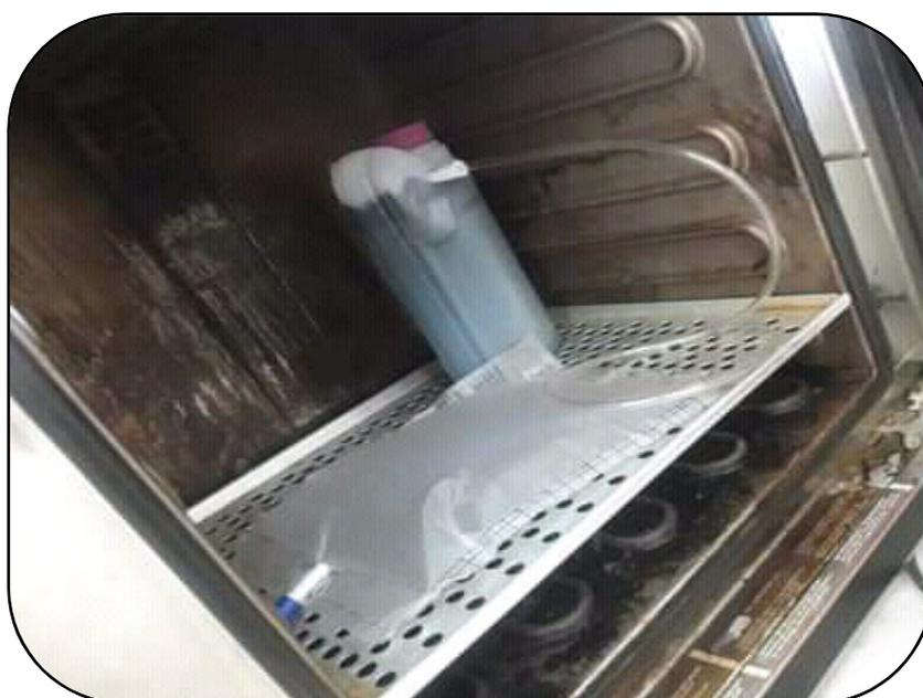
**Figure 7:** Montage du digesteur pour la production de biogaz (Photo originale)
