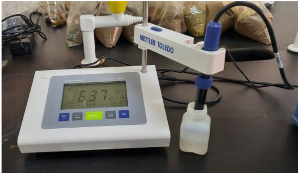
Figure (46) : Calibrage du Ph mètre (cliche BOUCHENTOUF,2023).
