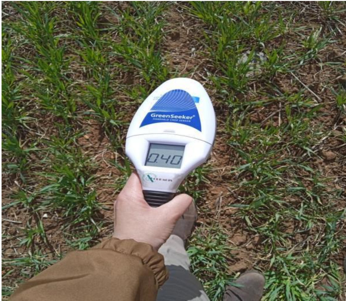
Figure (20) : le Green Seeker pour mesurer l'NDVI (cliché MEDDAH, 2023).
