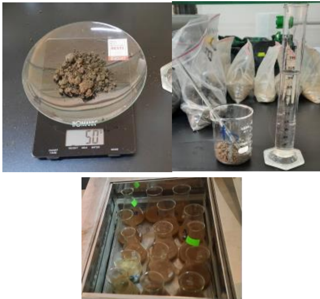
Figure (44) : Préparation des solutions du sol pour mesurer NPK (cliche BOUCHENTOUF,2023).
