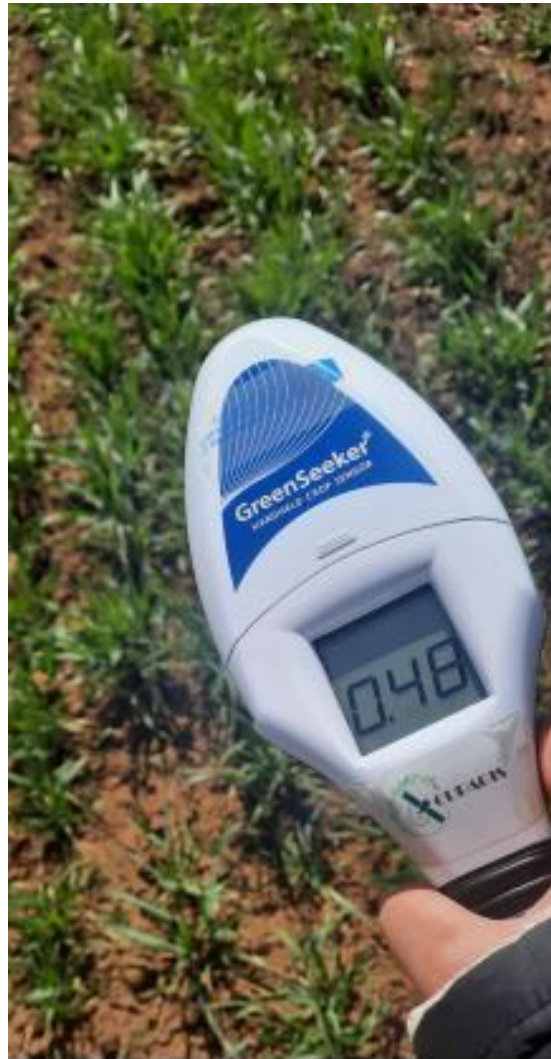
Figure (39) : Le capteur portatif GreenSeeker (cliche BOUCHENTOUF)
