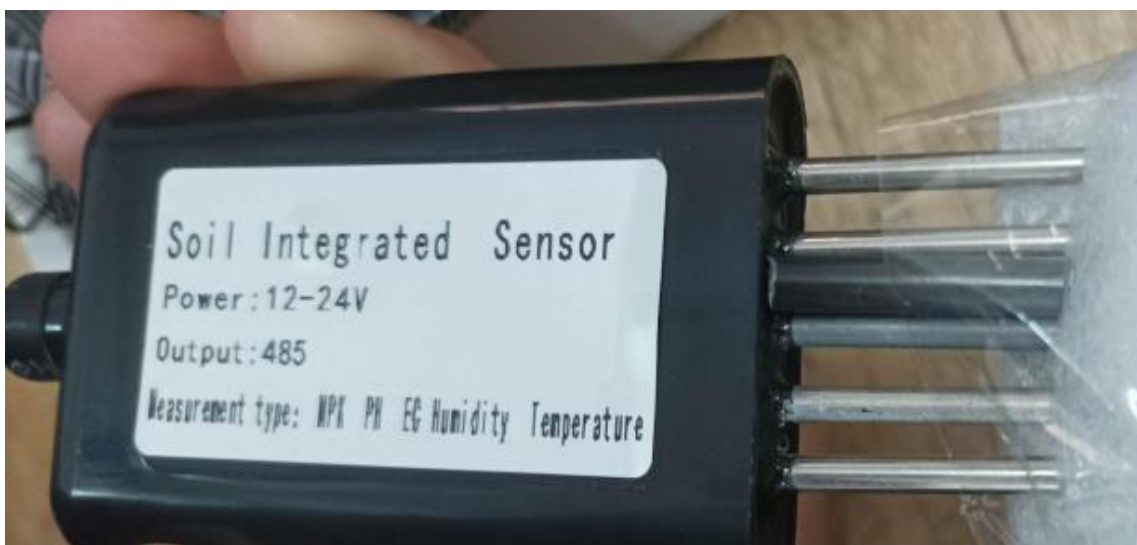
Figure (21) : capteur intégré pour mesurer les paramètres de sol (cliché MAHDI, 2022).
